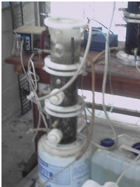
Foto 2.- Reactor aerobio (FSA)
