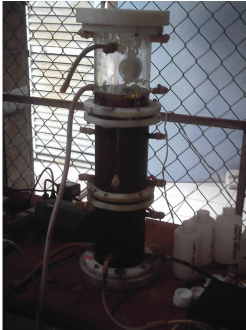
Foto 1.- Reactor anaerobio (FSAN)
