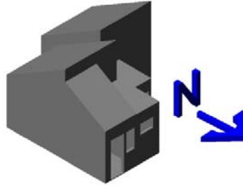
Figura 2.4 Dibujo del prototipo con losa plana y 30° de inclinación orientación Sur
