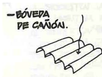
Figura 3.11 Losa en forma de bóveda de cañón
