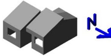
Figura 2.3 Dibujo del prototipo con losa plana y 20° de inclinación orientación Oeste
