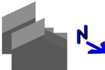
Figura 2.4 Dibujo del prototipo con losa plana y 30° de inclinación orientación Suroeste
