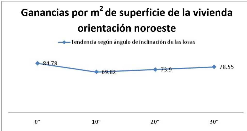
Gráfica 2.4 Comportamiento térmico de la vivienda al variar el ángulo de inclinación de las techumbres; las cantidades sobre la línea azul representan las ganancias máximas del sistema por m 2 en la orientación Noroeste.
