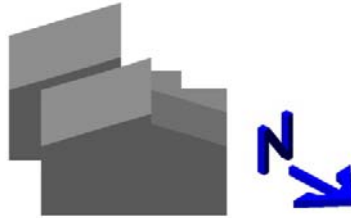
Figura 2.3 Dibujo del prototipo con losa plana y 20° de inclinación orientación Sureste
