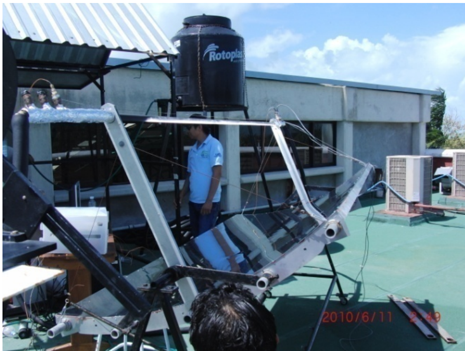
Figura 4. 11 Prototipo del CCP de 45 ° de ángulo de borde.
