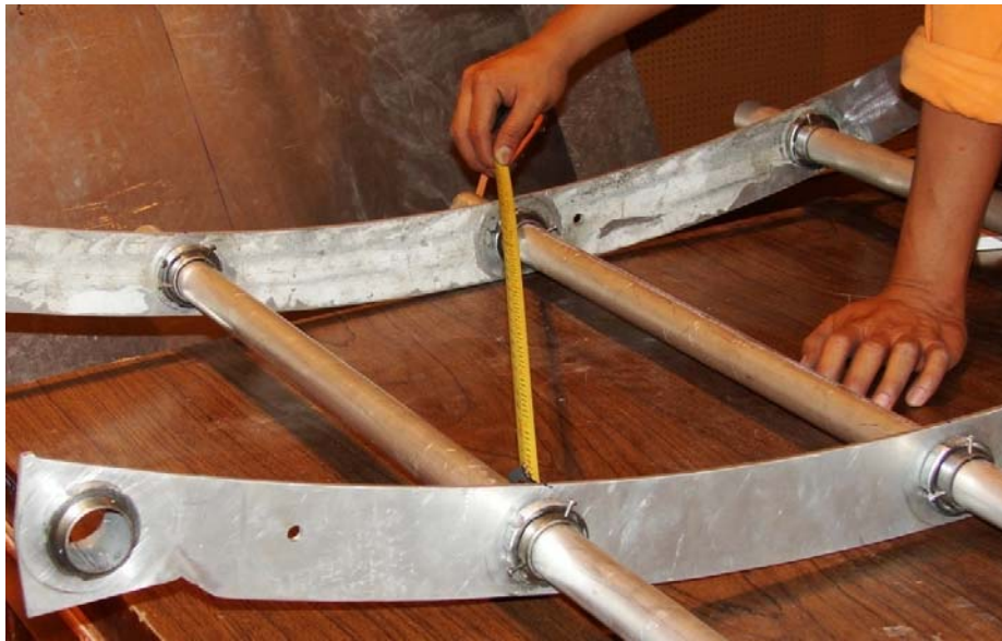
Figura 4. 9 Sistema de sujeción de las costillas del captador
