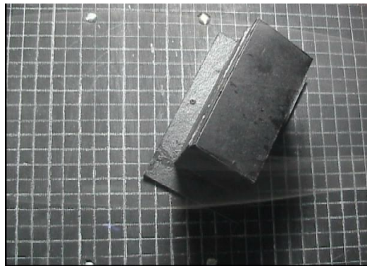
FIGURA 2.23 Sombra de viento en techo un agua
