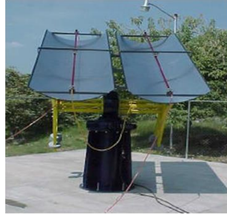
Figura 2.19 Concentrador CP de 2 grados de libertad.
