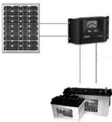
*Figura 2. 10 Sistema fotovoltaico de alimentación. Fuente: <http://www.nrgsystems.com/>*
