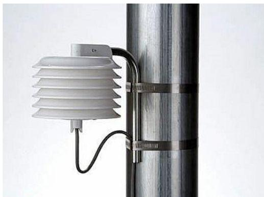
*Figura 2.6 Sensor de temperatura. Fuente: [www.nrgsystems.com](http://www.nrgsystems.com)*
