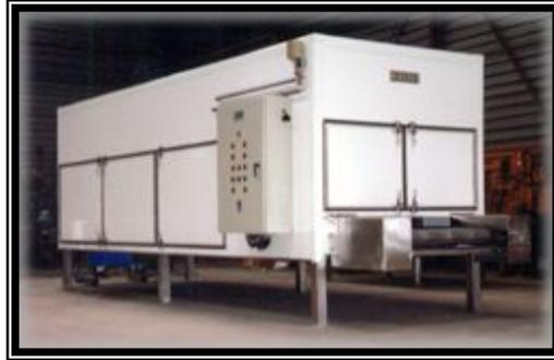
**Figura 1-6.- Secador continuo por deshumidificación para frutas semiconfitadas.**
