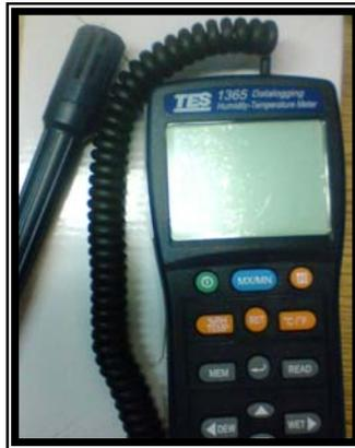
Figura 3-7.- Termo-higrómetro ubicado en el interior del túnel de secado.
