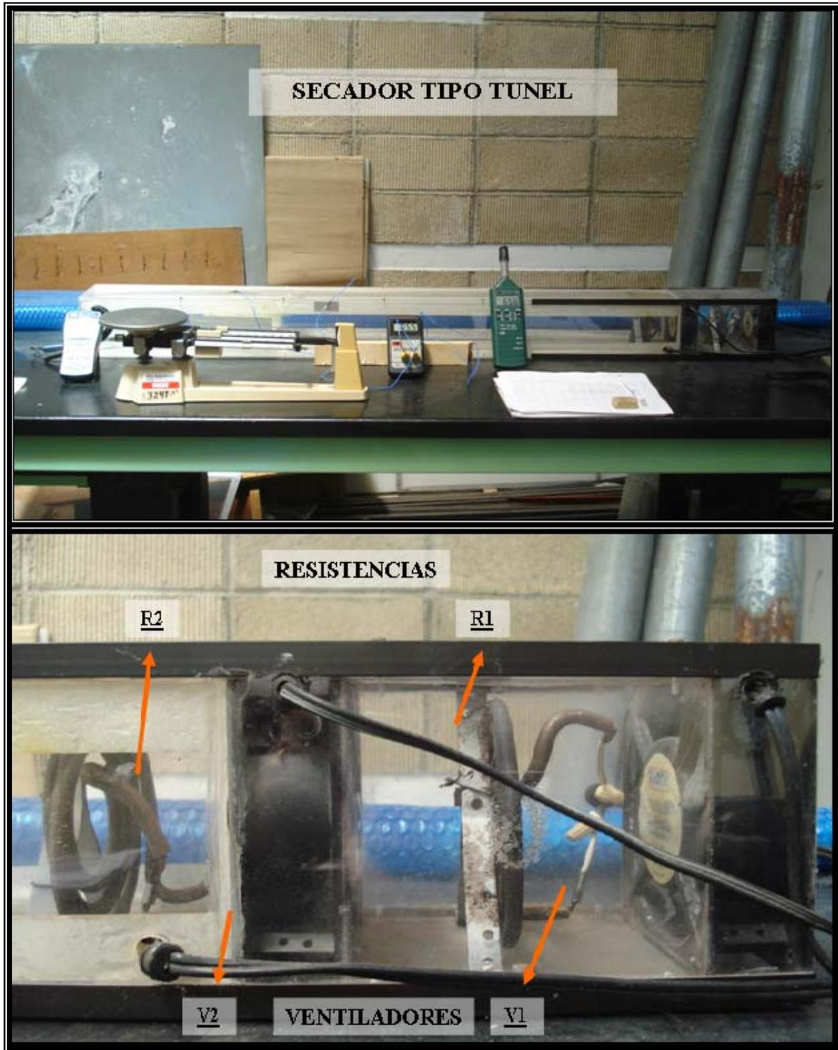
Figura 3-9.- Componentes del secador tipo túnel.
