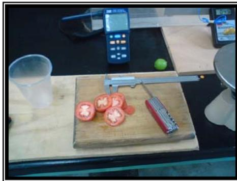
Figura 3-13.- Corte del jitomate en medallones de 5mm de espesor.
