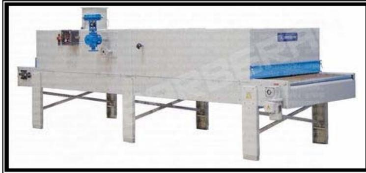
**Figura 1-9.- Secador tipo túnel.**
