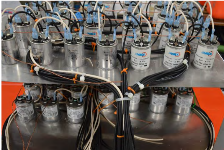
Fig. 3.10 Identificación de los capacitores fijos en la placa. (Yah, 2015)
