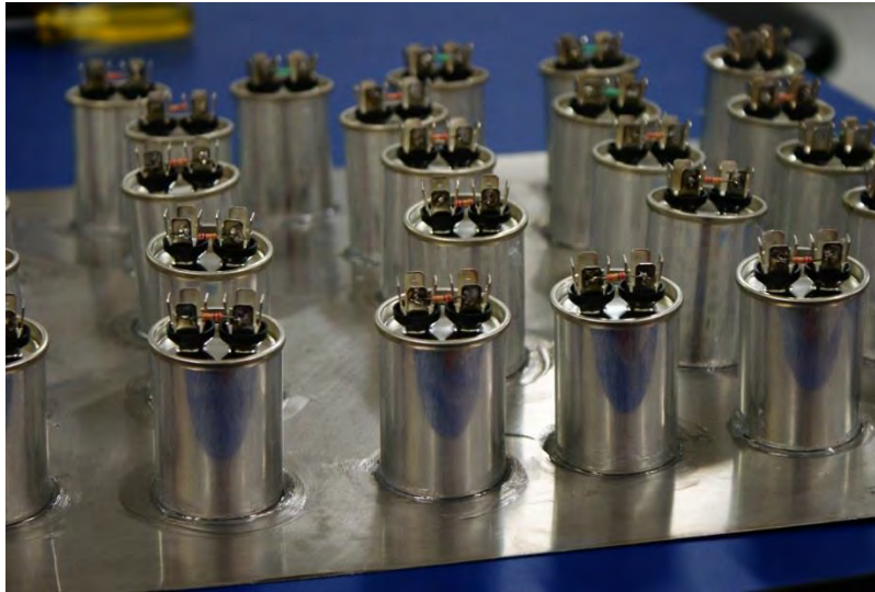
Fig. 3.6 Capacitores cortocircuitados con resistencias (Yah, 2015).
