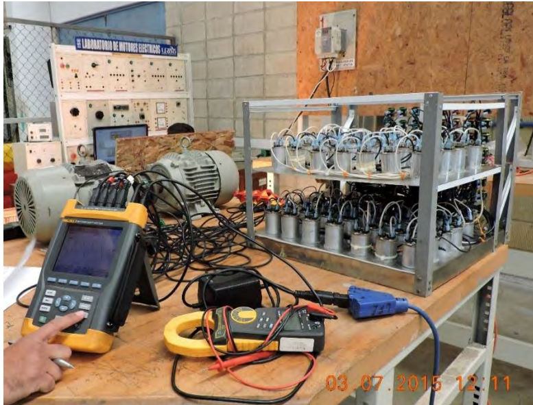
Fig. 3.29 Conexión del banco de capacitores y el equipo de medición (Yah, 2015).
