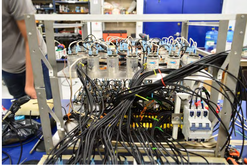
Fig. 3.20 Distribución de los capacitores (Yah 2015).
