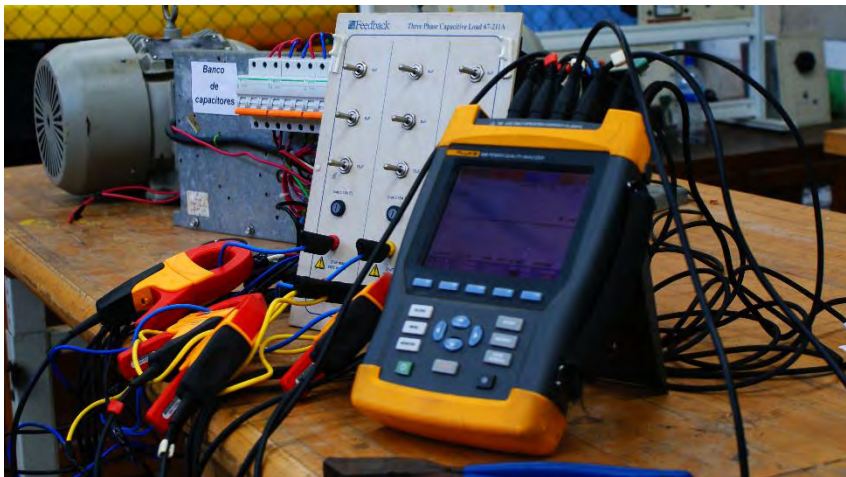
Fig. 2.8 Fotografía del equipo Fluke 424 (Power Quality Analyzer) (Yah 2015).
