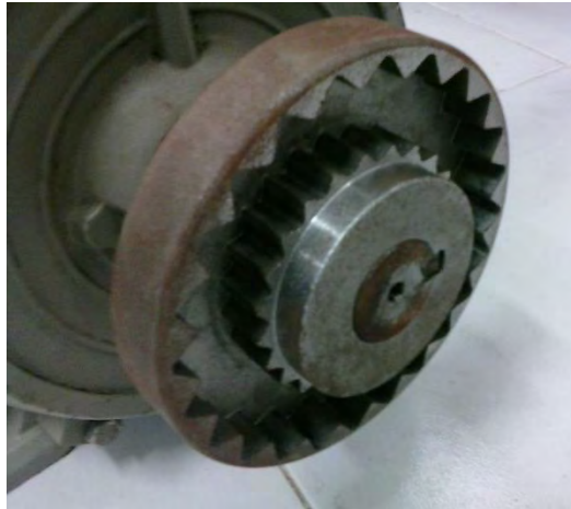
Fig. 3.2. Acoplamiento que tiene ambas máquinas (Yah, 2015).
