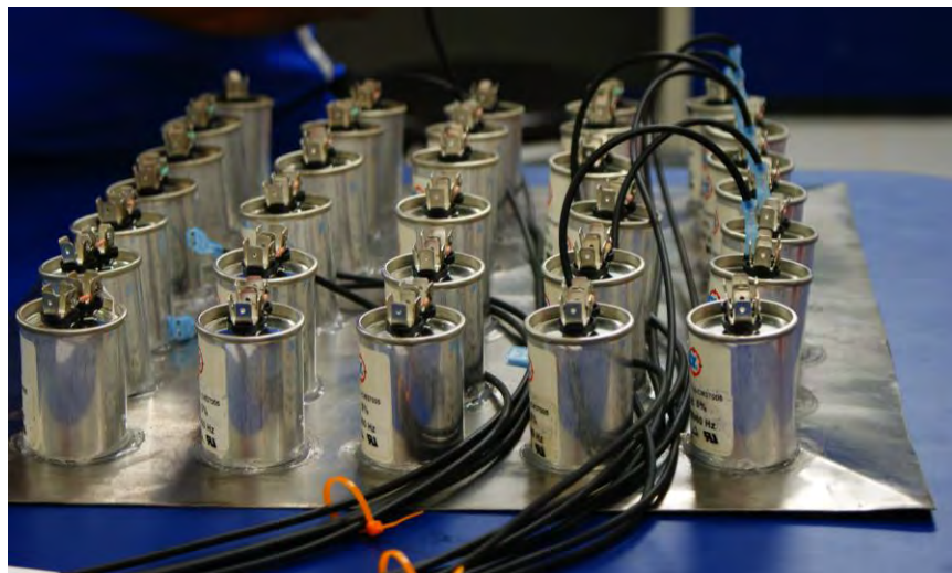
Fig. 3.11 Conexión de los capacitores e identificación de cada uno (Yah, 2015).
