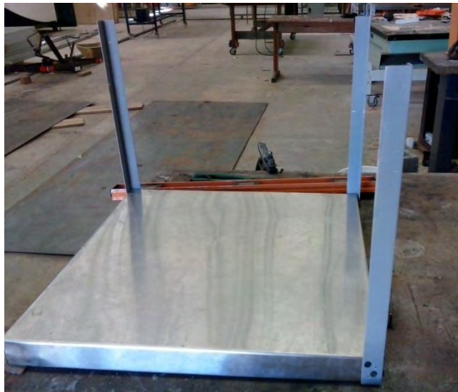
Fig. 3.7 Base para el banco, de lámina de acero inoxidable (Yah, 2015).
