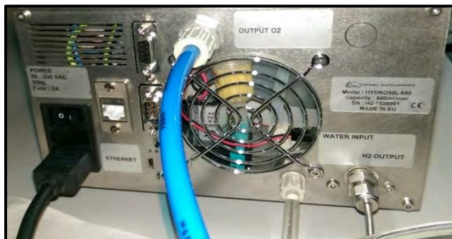
Figura 39. Conexiones realizadas al electrolizador.
