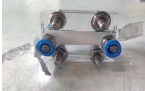
Figura 3.19 Celda 2 Construida, vista del lado ánodo.
