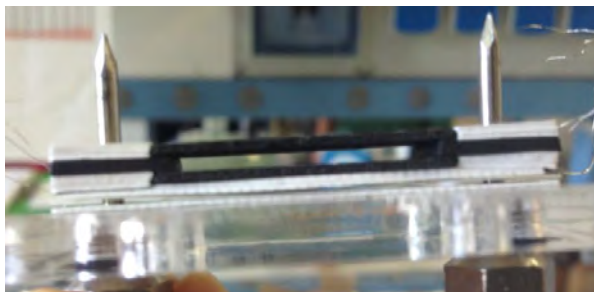
Figura 3.23 Celda 4 con GDL-K3 y el espacio creado por la capa de polímero para mejorar el transporte de masa.
