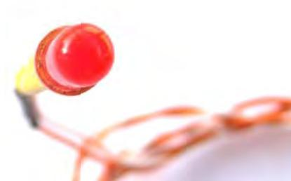
Figura 36 Conexión del LED activado por la alarma.
