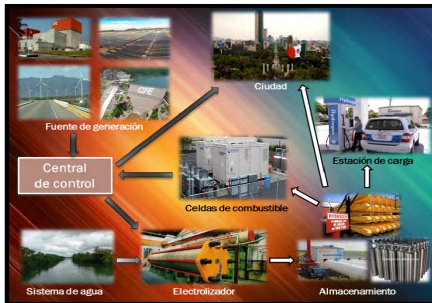
Figura 7. Sistema energético basado en hidrógeno (elaboración propia).
