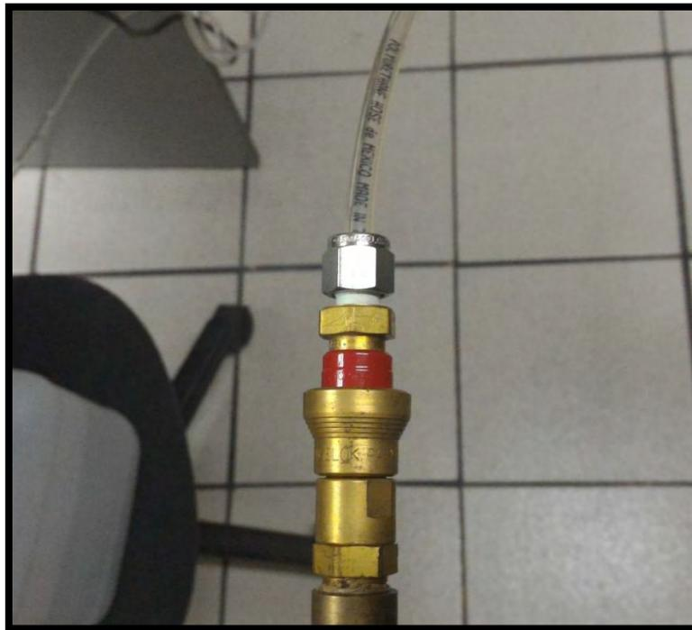
Figura 30. Conector del tanque de hidruros metálicos.
