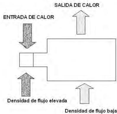
Figura 3.3 Modificación de la densidad de flujo de calor (FEFM, 2008)
