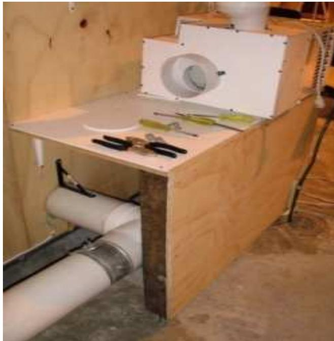
Figura 4.17. Ducto de aire secundario a la salida de la c mara clim tica y acoplado al d mper
