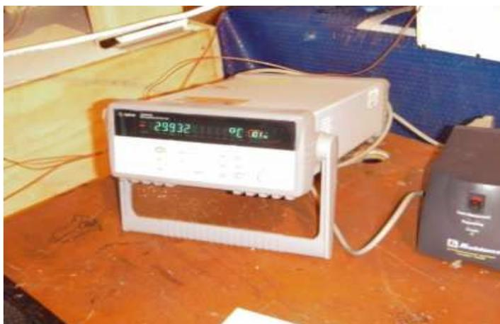
Figura 4.27 Equipo de adquisición de datos marca Agilent modelo 34970A.
