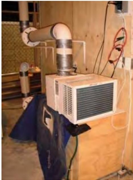
Figura 4.15. Ducto de aire primario a la salida de la unidad de aire acondicionado.
