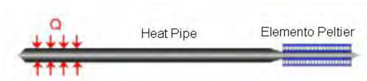
Figura 3.18 Tubo de calor combinado con elemento Peltier (Vasiliev, 1995).
