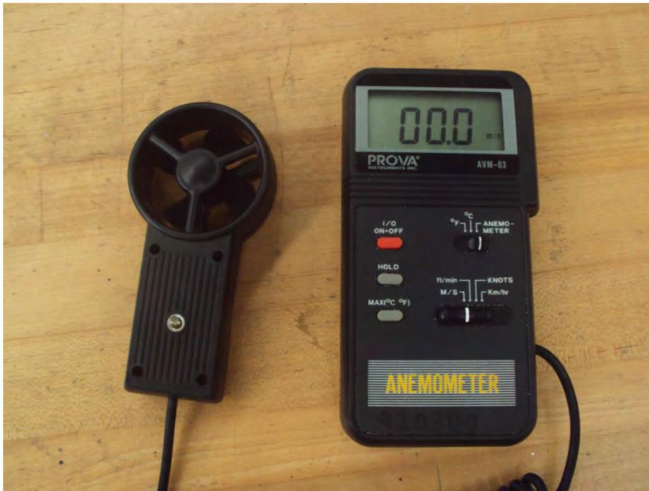
Figura 4.31 Anemómetro de tipo turbina marca PROVA modelo AVM-03.
