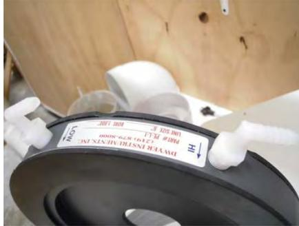
Figura 4.23. Placa de orificio utilizada para medir el flujo de aire en la instalación.
