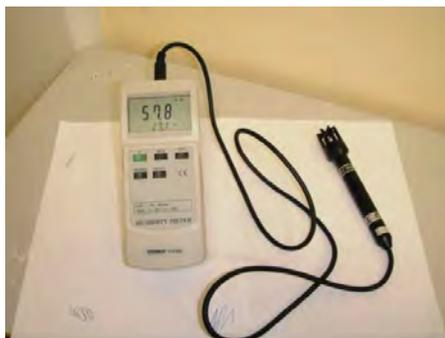
Figura 4.28 Termo higrómetro de la marca TENMA, Modelo 72-6785A.
