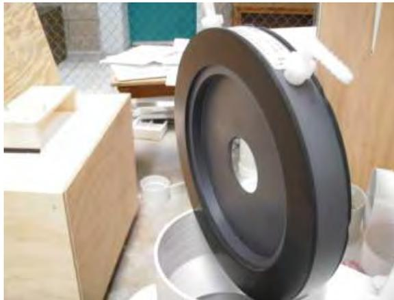
Figura 4.20 Placa de orificio previa a su montaje con las bridas de sujeción.
