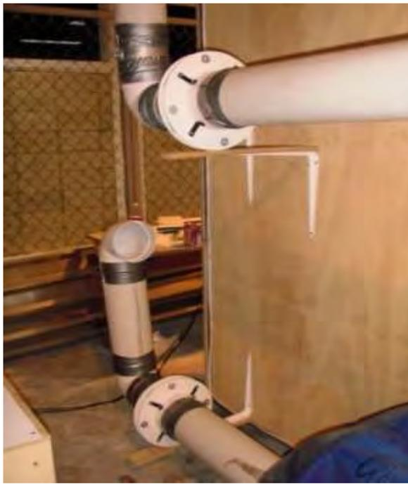
Figura 4.18. Ducto de aire secundario acoplado a la placa de orificio.
