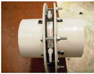
Figura 4.22. Vista lateral de la placa de orificio con sus bridas de sujeción.
