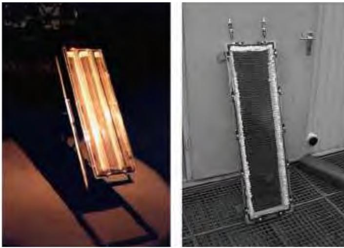
Figura 3.20 Colector solar prototipo de tubos de calor con membranas delgadas (Riffat, 2005).
