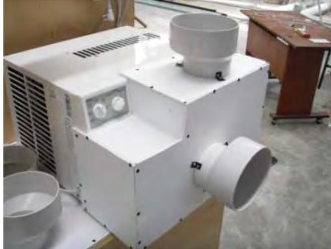
Figura 4.25. Cámara de admisión de aire atmosférico y de descarga del aire primario.
