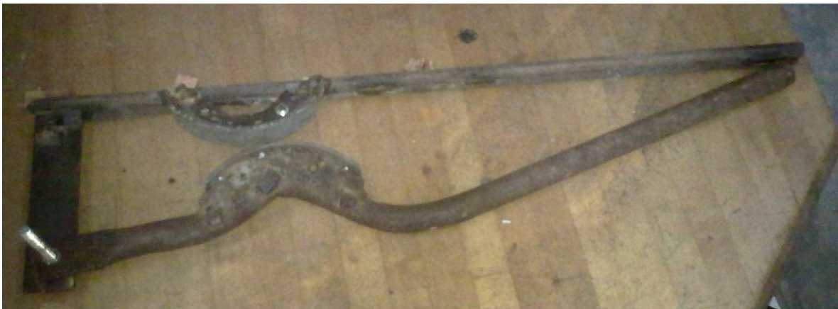
Fig. 2.13 Dispositivo de frenado a base de Clutch de motocicleta
