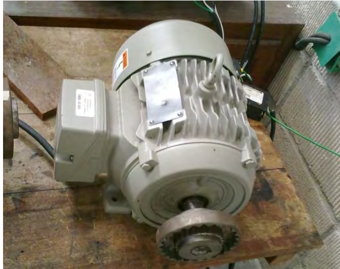
Fig. 2.16 Motor con acoplador fijado al eje del rotor.
