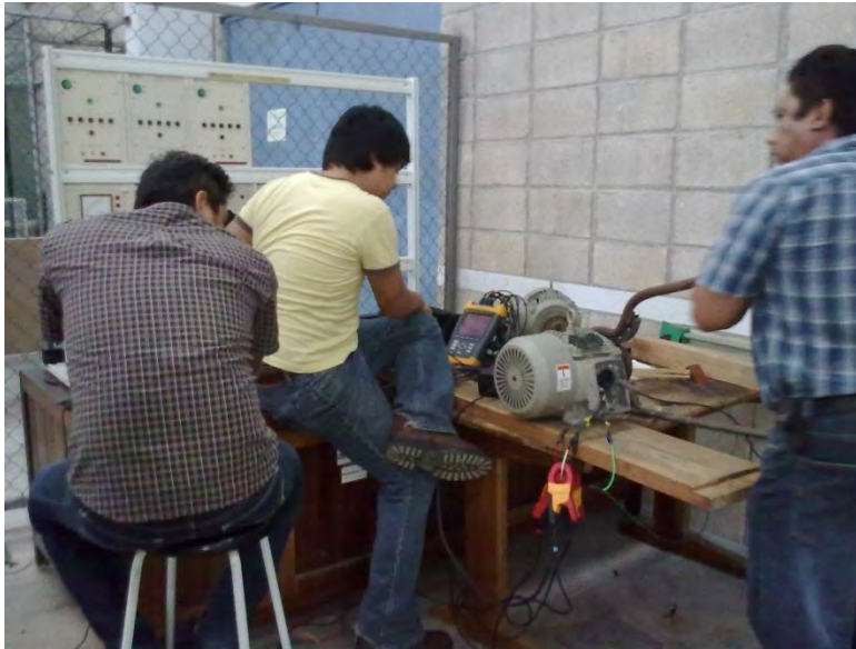
Fig. 2.12 Imagen durante la prueba de rotor bloqueado.
