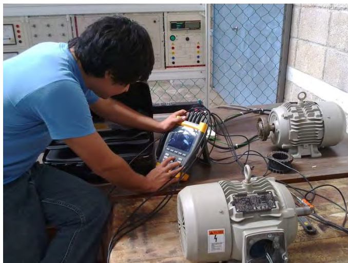
Fig. 2.5 Realización de la prueba de vacío.
