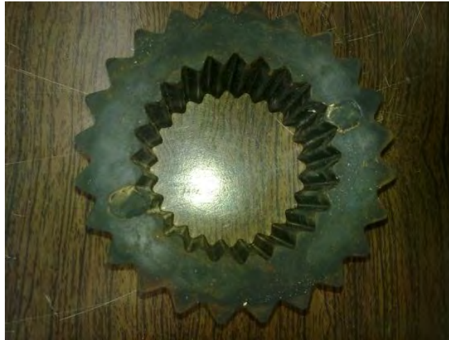
Fig. 2.17 Pieza plástica amortiguadora para el sistema de acoplamiento de motores.
