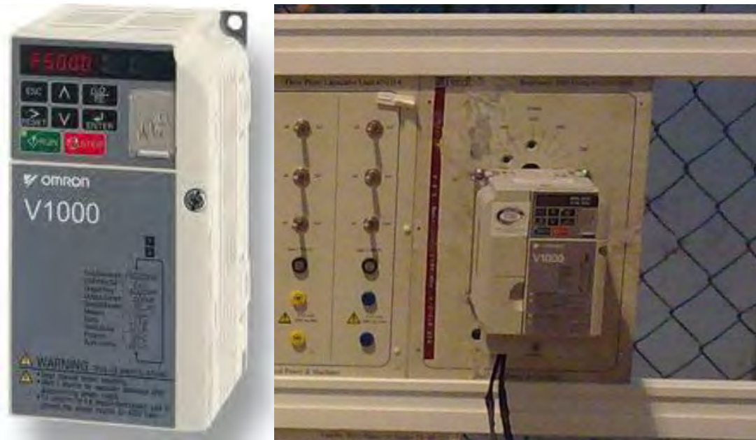
Fig.2.15 Variador de frecuencia V1000 y montaje del mismo en el módulo de motores Feedback.
