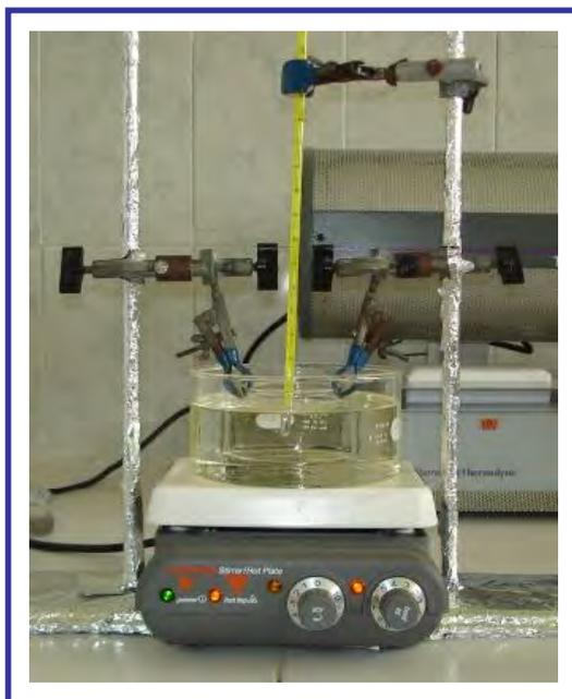
**Figura 3.6** Montaje del equipo para la activación de las membranas de Nafion<sup>®</sup> 117.
