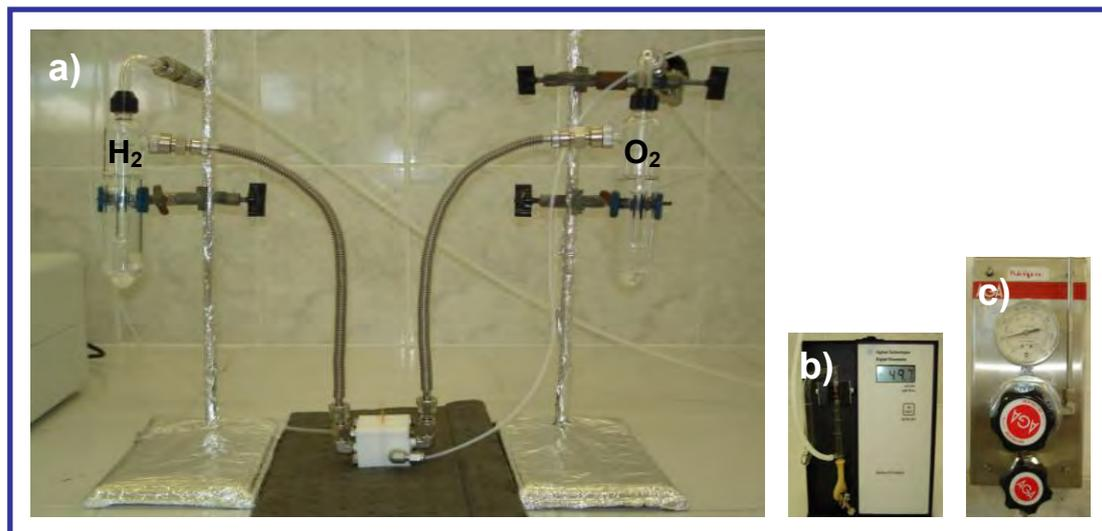
**Figura 3.12** Fotografías que muestran: (a) Montaje del equipo implementado para las pruebas experimentales, (b) Fluómetro, y (c) Manómetro.
