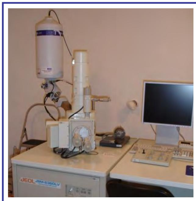
Figura 3.5 Fotografía del microscopio electrónico de barrido.
