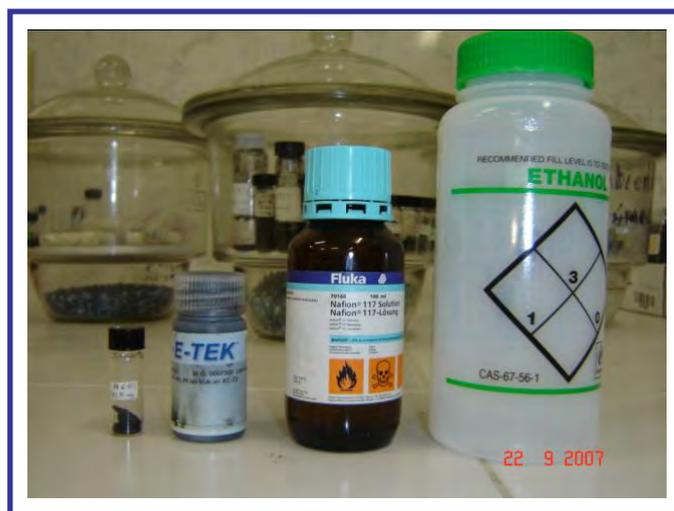
**Figura 3.1** Fotografía de los componentes de la tinta catalítica, de izquierda a derecha: Pt/NTC, Pt/Vulcan XC-72R, solución de Nafion<sup>®</sup> 117, etanol.
