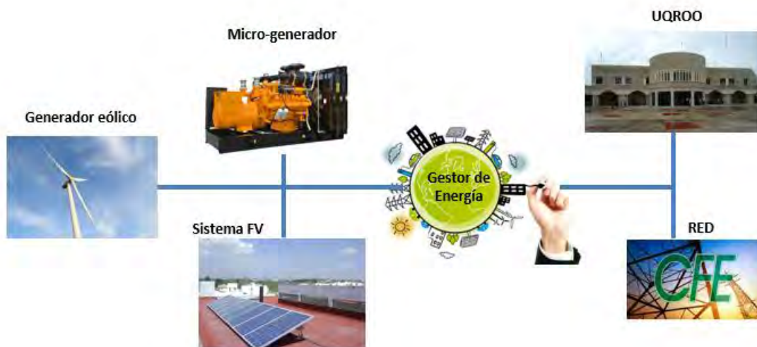
Figura 3.6. Esquema de la MR bajo tres fuentes de generación operado por un gestor de energía.
