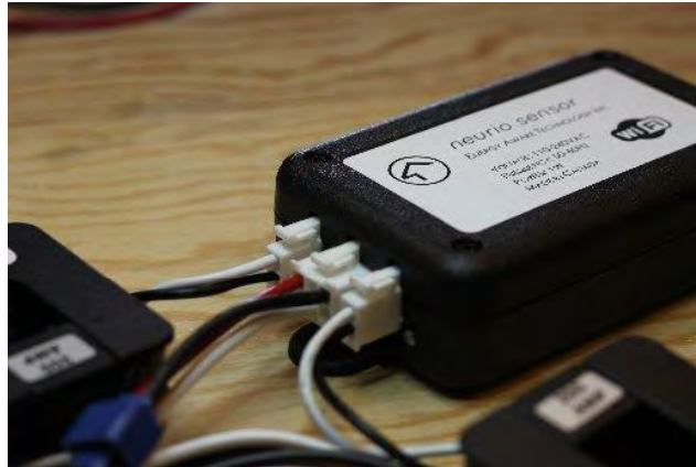
Figura 31.- Dispositivo Energy Aware para IoT.
