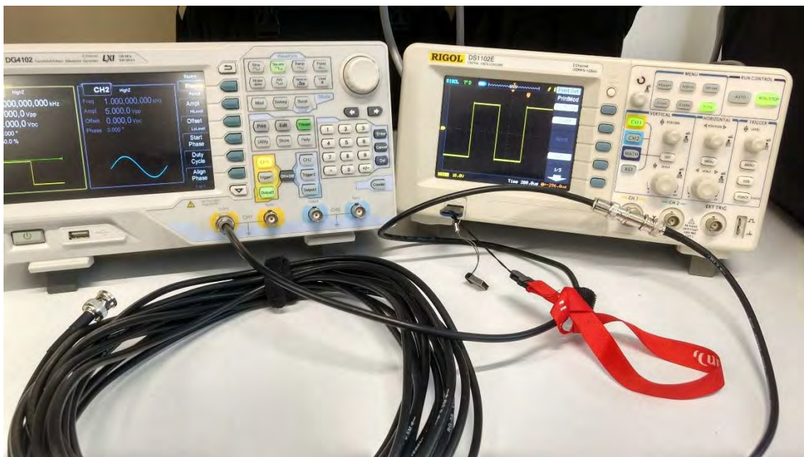
Figura 40 Diagrama utilizado. Generador de funciones, osciloscopio y cable coaxial a medir
