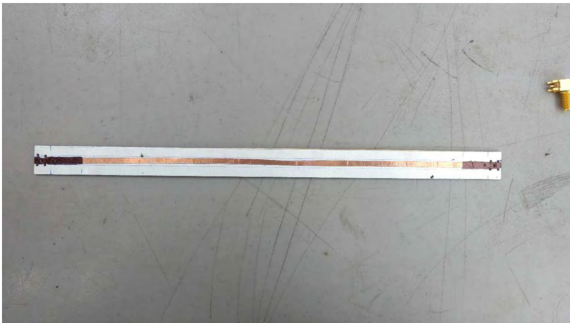
Figura 35 Línea de transmisión por la parte superior donde se puede apreciar la línea conductora
