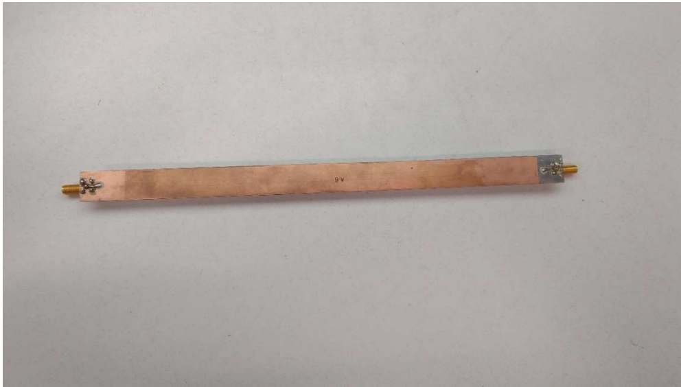
Figura 38 Conectores mcx soldados a la línea de microcinta
