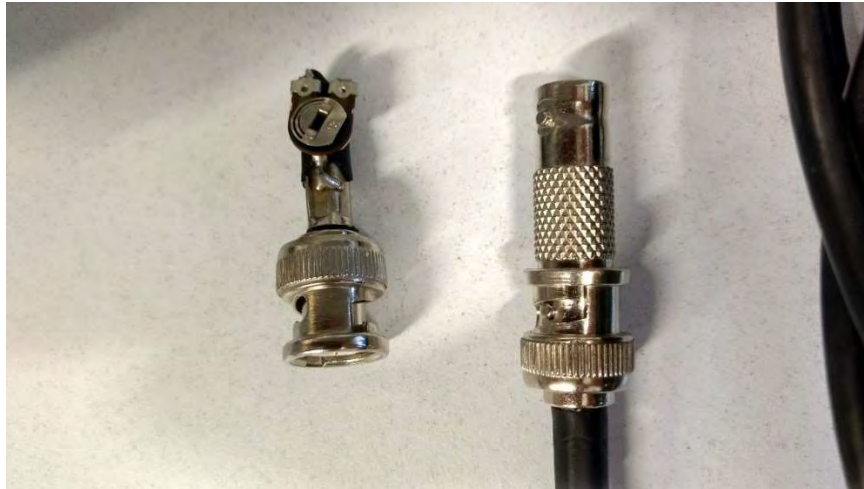
Figura 45 A la izquierda el potenciómetro, a la derecha el extremo en circuito abierto del coaxial
