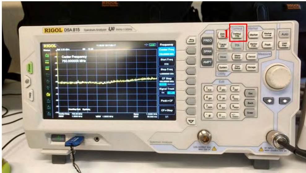
Figura A2.10 Se ajusta el tiempo de muestreo con el botón SWEEP/TRIG (1)
