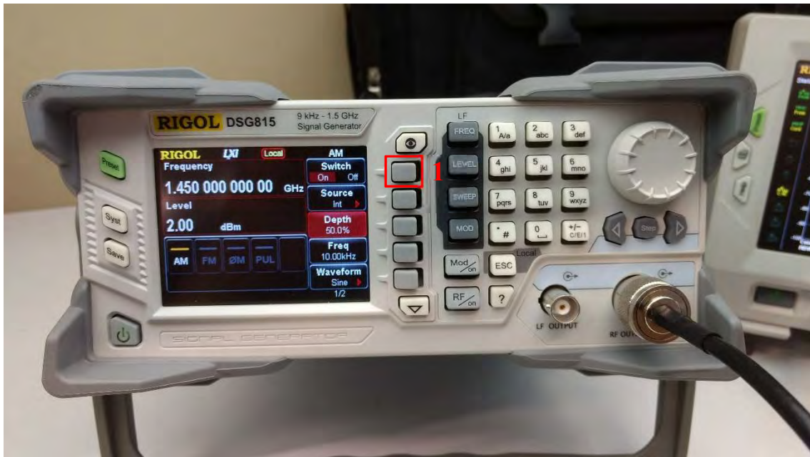
Figura 62 Se activa la modulación en amplitud (1)
