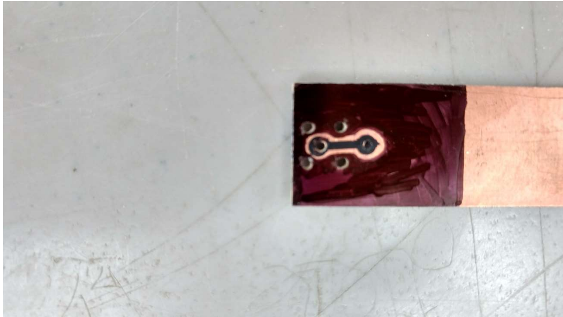
Figura 36 Diseño para evitar que el conector mcx toque la línea conductora y provoque interferencias
