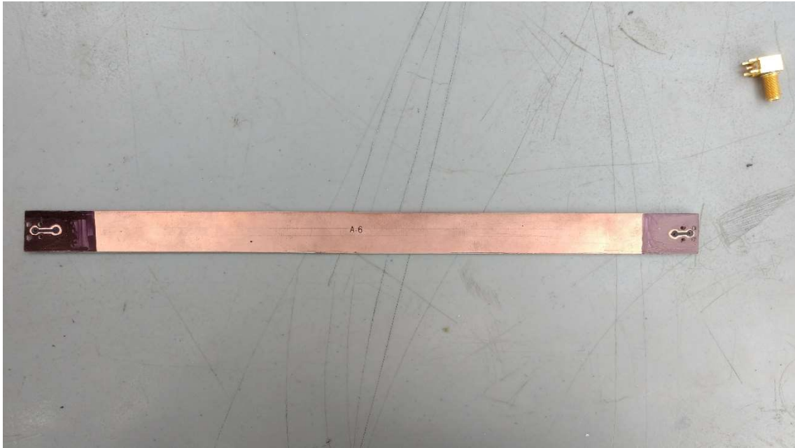
Figura 34 Línea de microcinta de 30 cm de longitud
