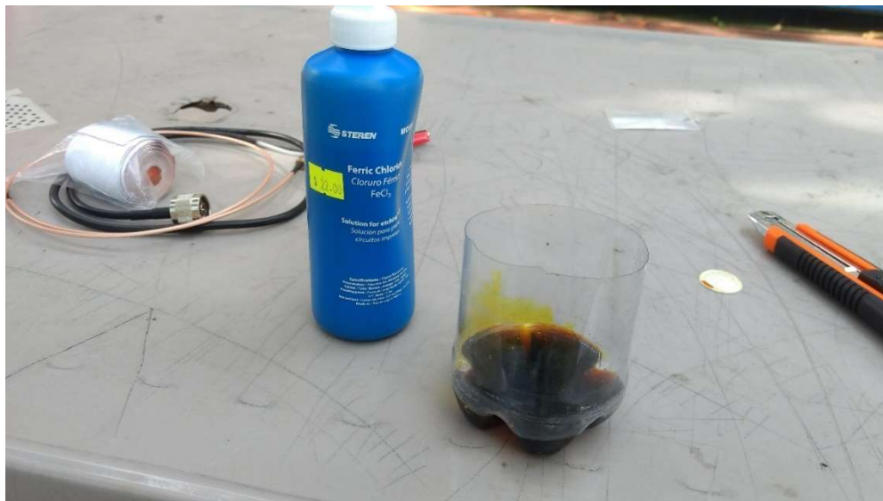
Figura 37 Acido férrico para disolver la parte sobrante de cobre en la línea de transmisión
