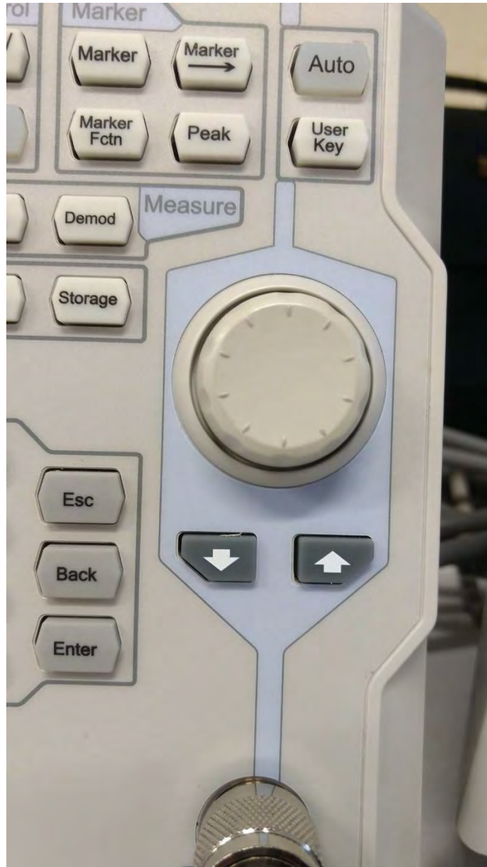
Figura A2.22 Se puede cambiar la escala por división de tiempo con la rueda o las flechas
