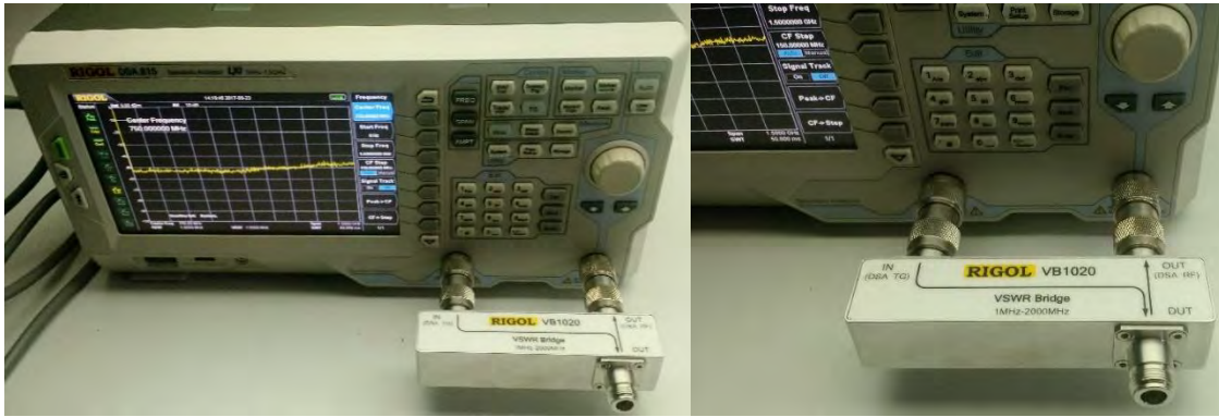
Figura 4.40 Puente VSWR conectado al analizador de espectro
