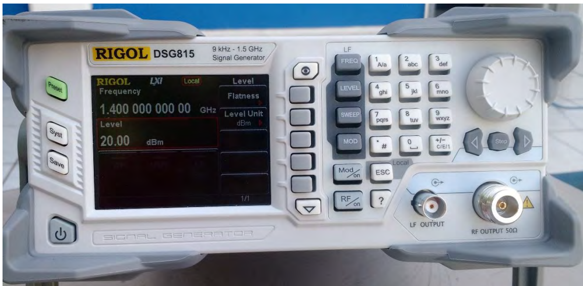
Figura 4.106 Configuración de la amplitud en el generador de señales
