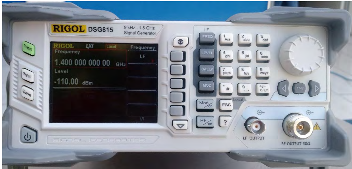
Figura 4.105 Configuración de la frecuencia en el generador de señales
