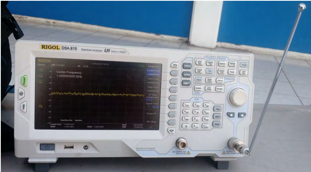
Figura 4.111 Configuración de frecuencia en el analizador de espectro
