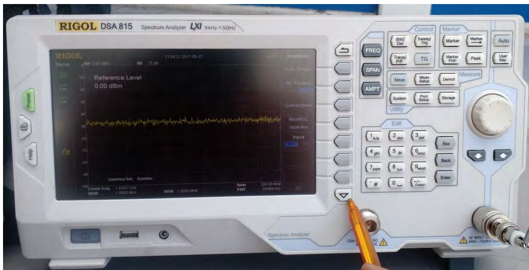
Figura 4.112 Configuración de amplitud en el analizador de espectro
