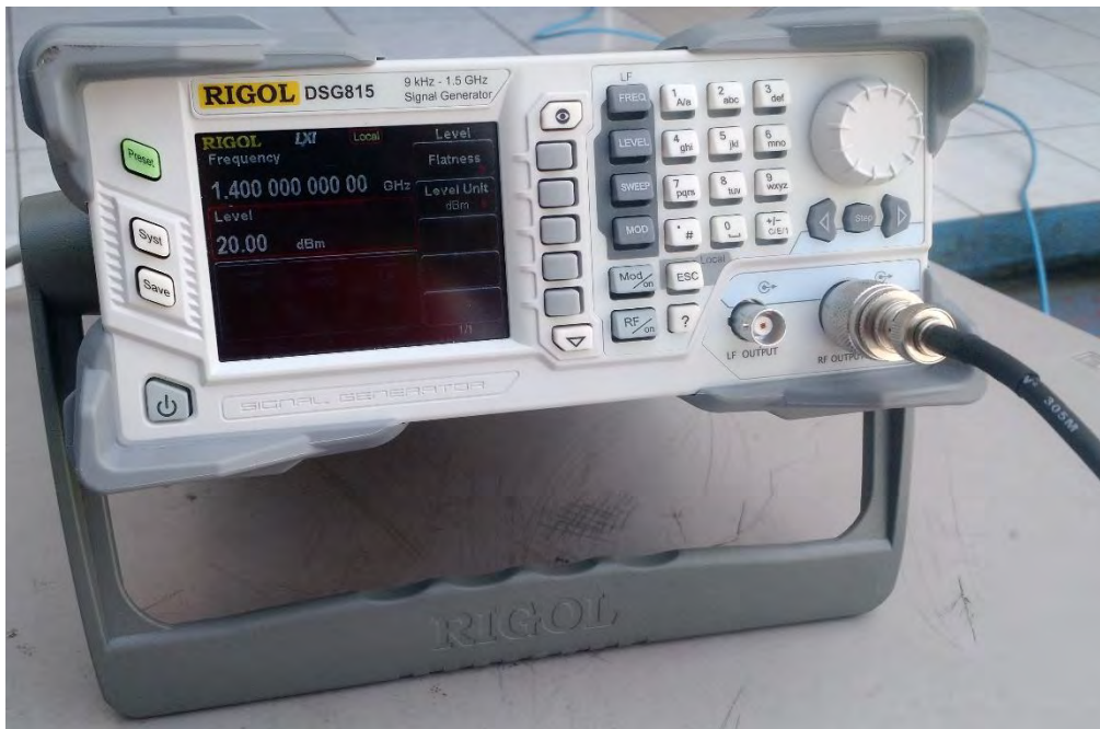
Figura 4.108 Conexión del generador de señales y el pigtail.
