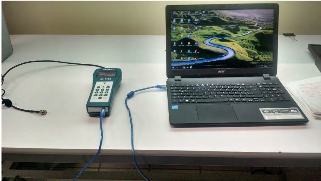
Figura 4.72 Conexión del analizador de antenas con la computadora
