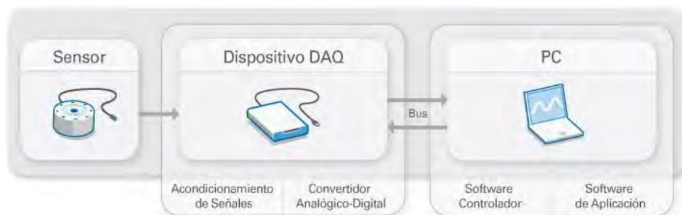
**Figura 2.1** sistema de adquisición de datos
