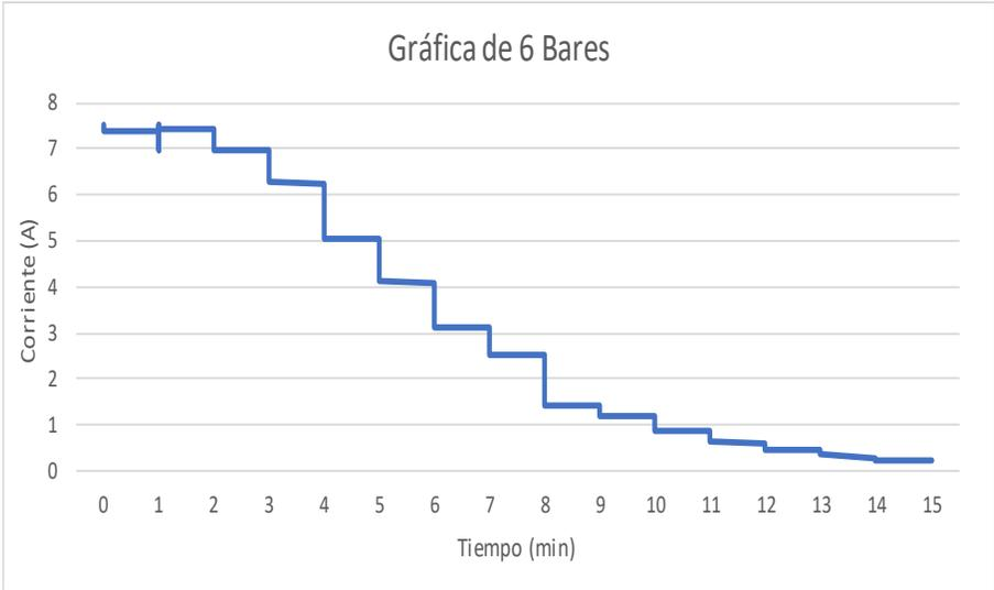
Figura 5.6 gráfica de corriente para el punto de control de 6 bares asignado al electrolizador.
