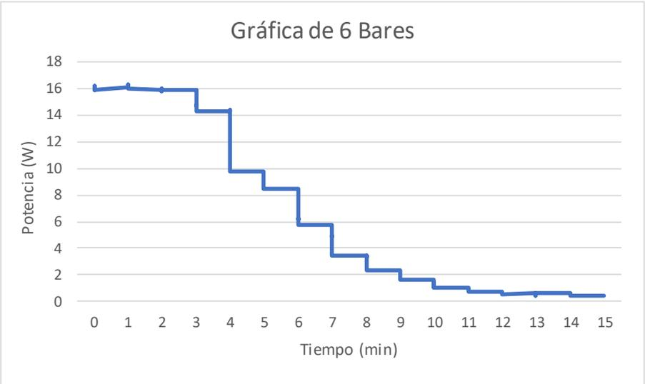
Figura 5.9 gráfica de potencia para el punto de control de 6 bares asignado al electrolizador.
