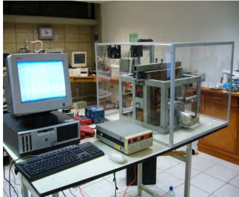
Figura 2.3-1. Conductímetro de placa caliente guardada.
