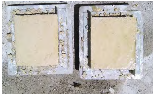
Figura 2.2-4. Compuesto 1:1:5 en espera de desmoldar.
