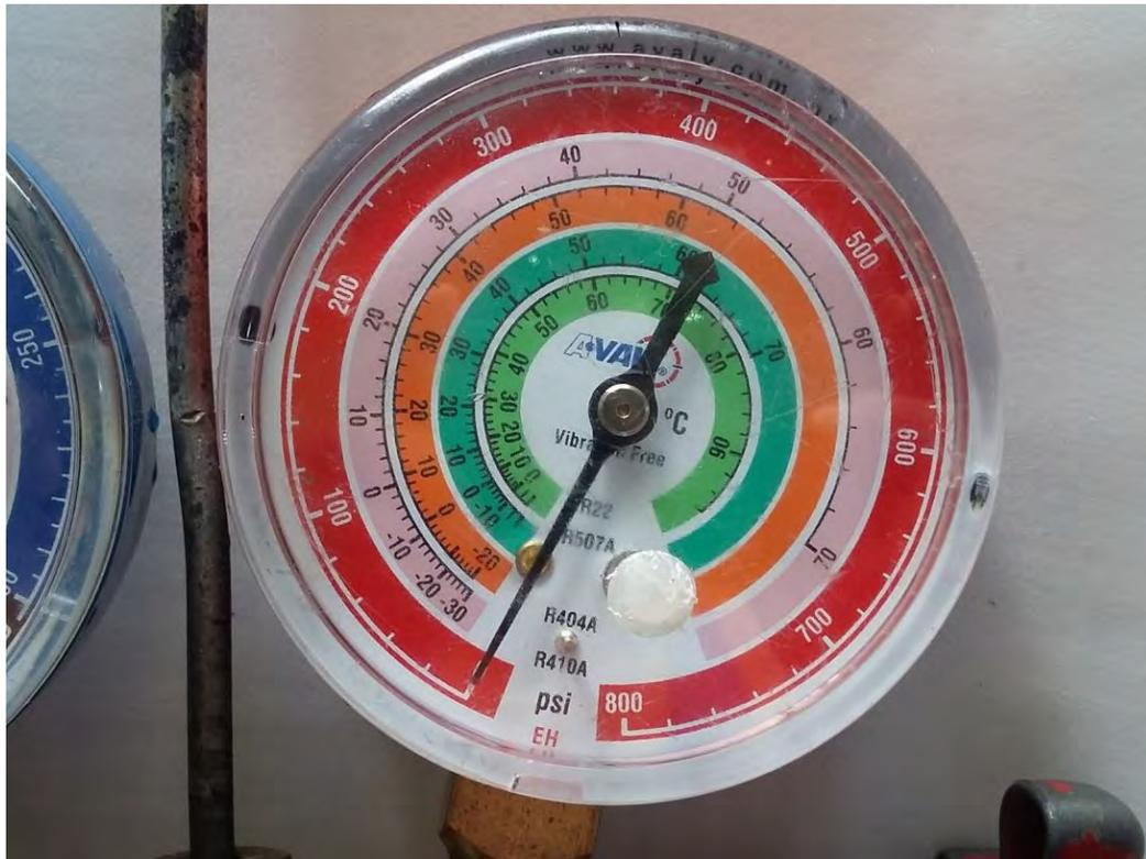
*Figura 1.9 Manómetro de alta presión (Fuente: elaboración propia).*
