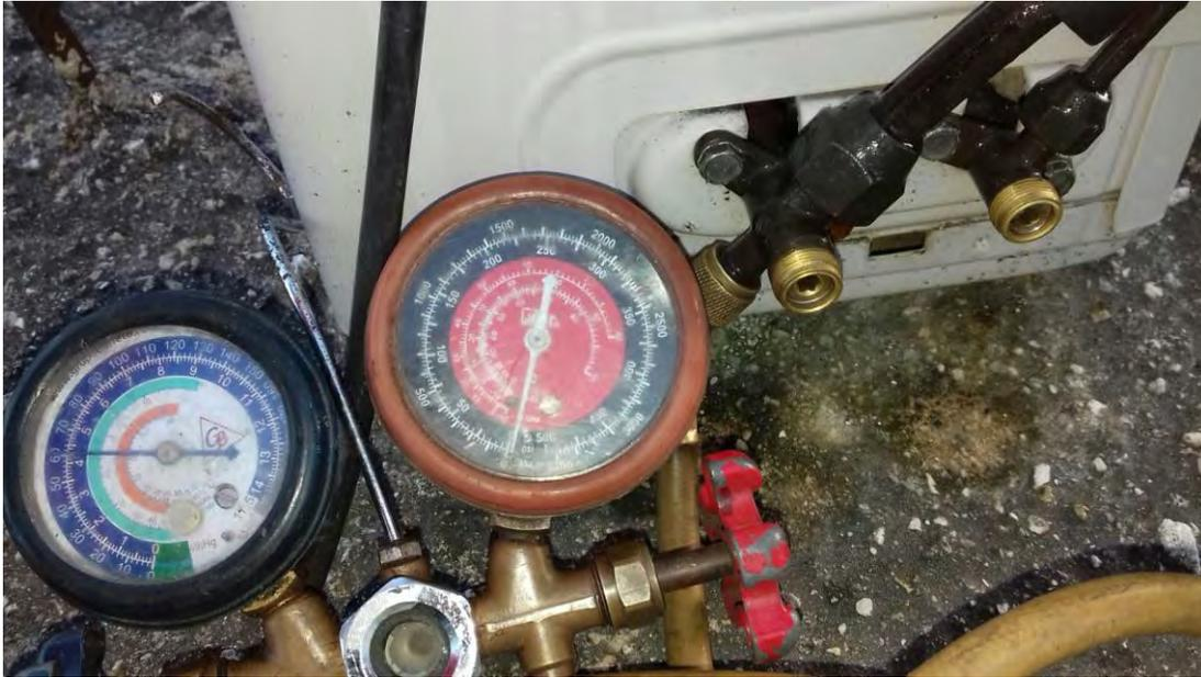
*Figura 3.13 Operando el equipo a 60 psi (Fuente: elaboración propia).*
