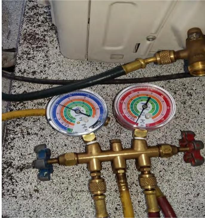
*Figura 3.12 Presión del refrigerante a 100 psi (Fuente: elaboración propia).*
