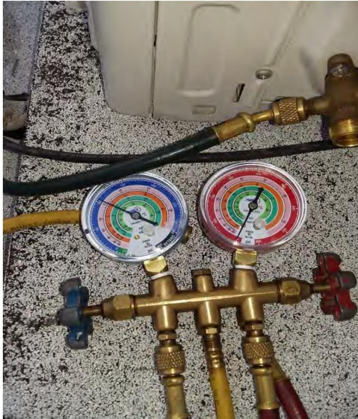
*Figura 1.10 Conexión del juego de manómetros a un equipo de aire acondicionado (Fuente: elaboración propia).*
