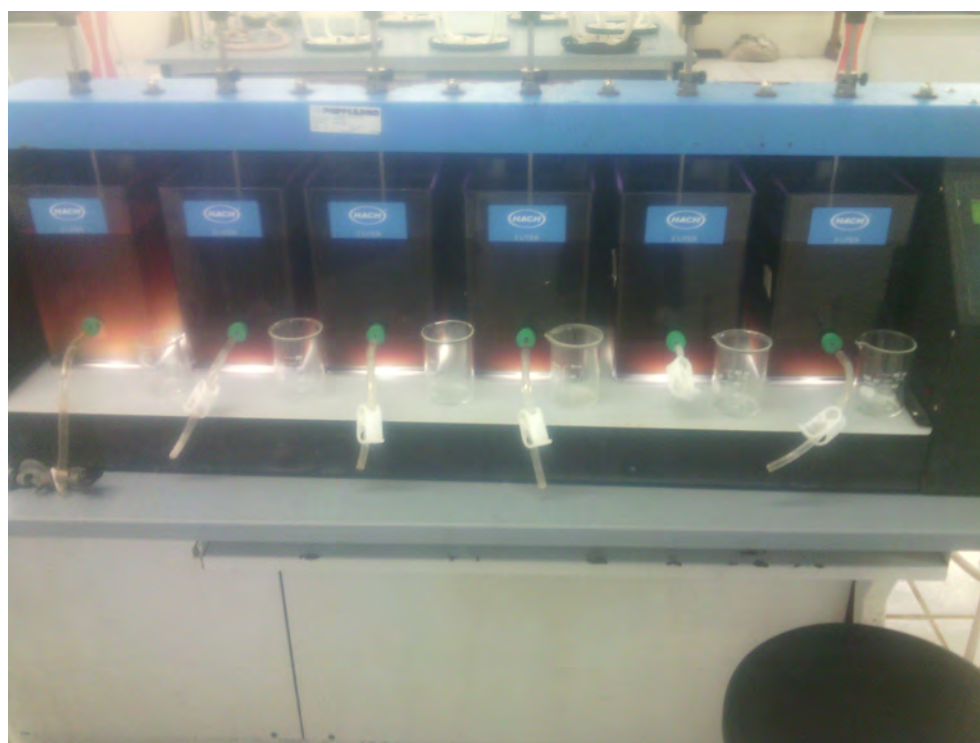
Figura 73 Prueba de jarras con las muestras sintéticas y el coagulante de Aloe barbadensis al 30%
