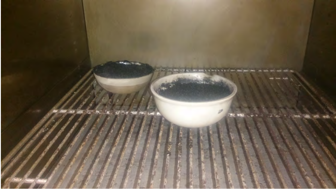
Figura 66 Activación química con ácido fosfórico del carbón triturado
