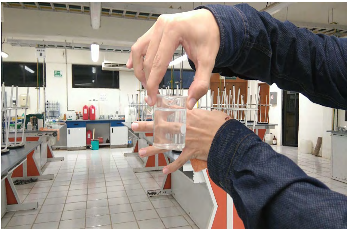
Figura 77 Agua residual de baja concentración de DQO depurada con el coagulante al 30% y la filtración de carbón activado
