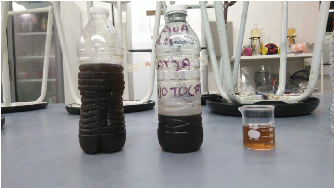
Figura 75 (izquierda a derecha) muestras sintéticas y su reducción de la turbiedad por coagulación-floculación empleando el coagulante al 30% y filtración
