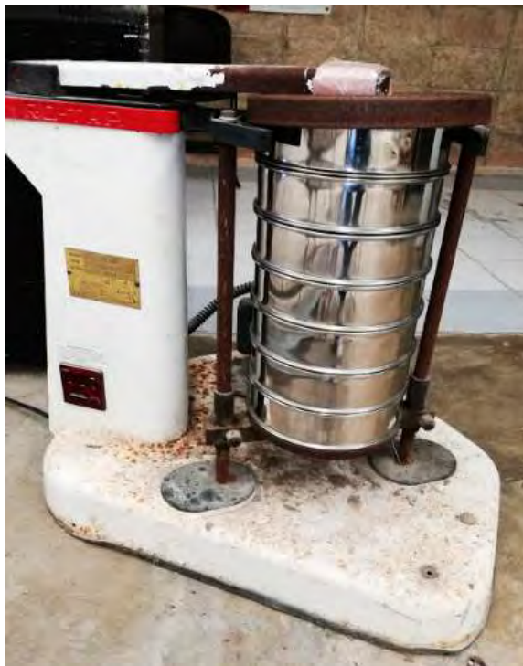
Anexo 10. Análisis granulométrico utilizando el método de tamizado a través de un mezclador marca RO-TAB RX-29
