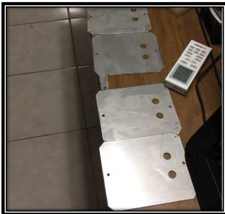
*Figura 3.7 Placas bipolares del electrolizador  $\alpha$ .*
