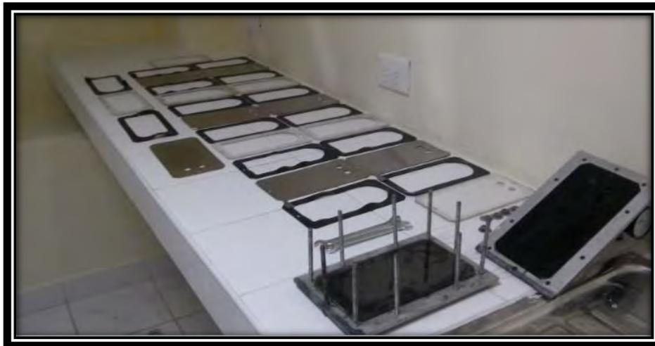
*Figura 3.4 Total de piezas del electrolizador de referencia  $\beta$ .*
