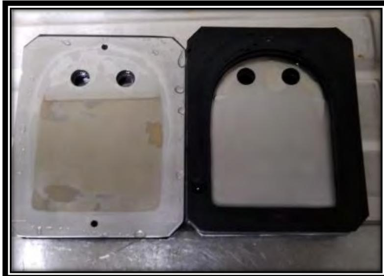
Figura 3.11 Oxidación de placa bipolar en el extremo del ánodo.
