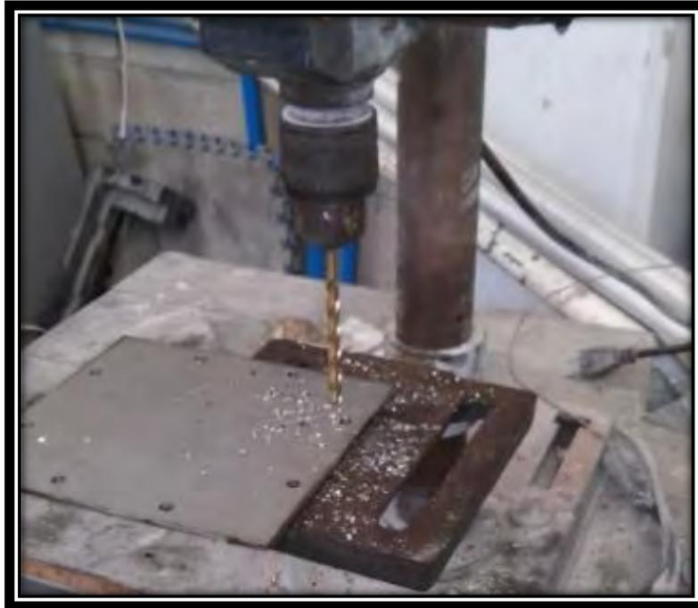
*Figura 3.9 Perforación de placas finales.*
