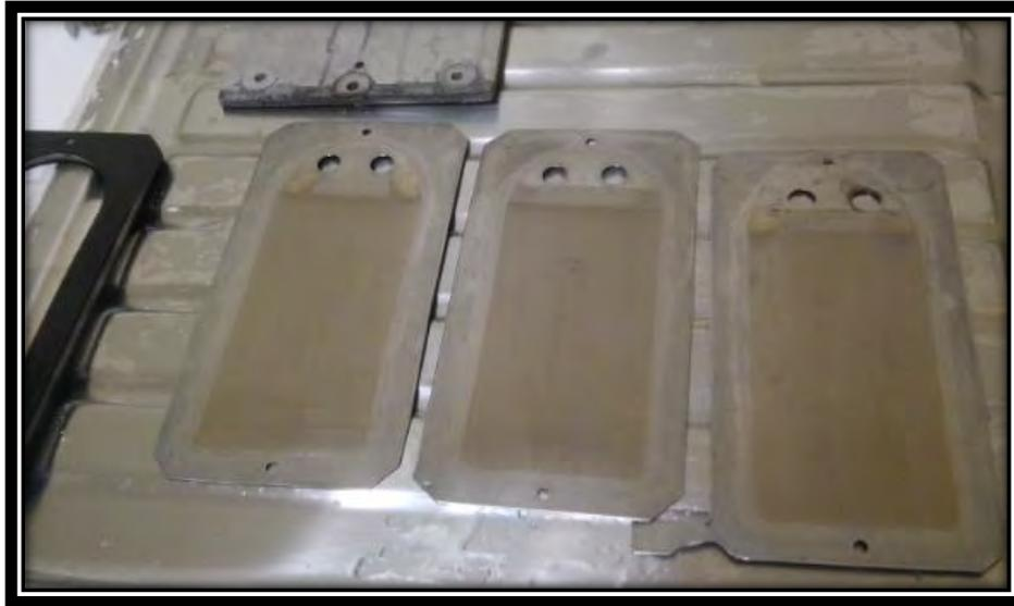
*Figura 3.3 Formación de la película de tono amarillento en las placas bipolares.*
