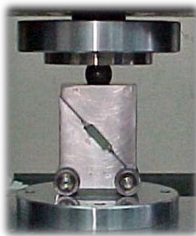
**Figura 2.8.** Dispositivo para pruebas de adhesión [18].
