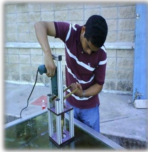
**Figura 3.4** Corte de vidrios con taladro con broca de punta de diamante de 30 mm de diámetro.
