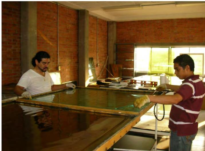
**Figura 3.1** Deposito de baño químico realizado en el Instituto de Energías Renovables (antes Centro de Investigación en Energía) de la UNAM.
