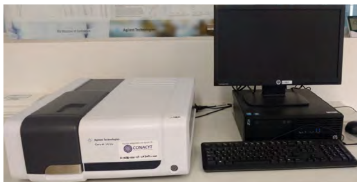
Figura 21 Equipo utilizado para la caracterización de UV-visible
