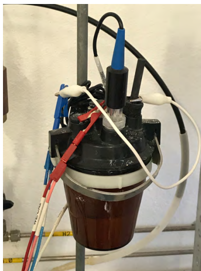
Figura 36 Celda de 3 electrodos utilizado para la voltamperometría cíclica.
