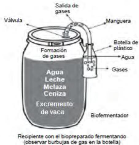
V: Colocar el recipiente que contiene la mezcla a la sombra, para que repose a temperatura ambiente, protegiéndolo del sol y las lluvias. La temperatura ideal sería la del rumen de los animales poligástricos como las vacas, más o menos 38 °C a 40 °C.
