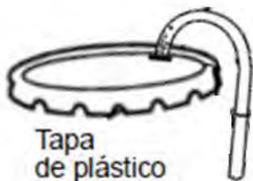
II: Introducir un extremo de la manguera por el hoyo de la tapa del contenedor de 20 lt a una distancia de 5cm de la orilla y fijarla bien con el pegamento, verificando que no tenga fugas.
