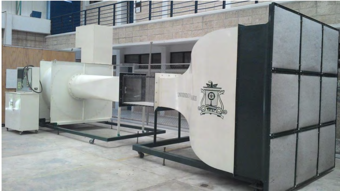
Figura 25. Zona de Acondicionamiento del Túnel de Viento de Fábrica.
