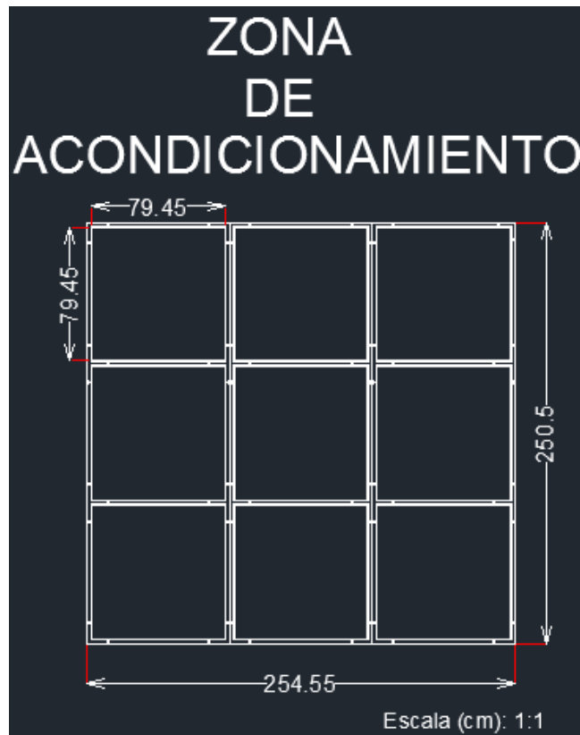
Figura 9. Vista Frontal (zona de acondicionamiento de flujo) del Túnel de Viento.
