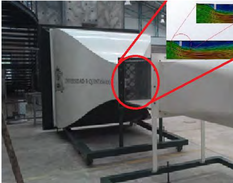
Figura 21. Cejas o bordes entre la zona de contracción y la cámara de pruebas.
