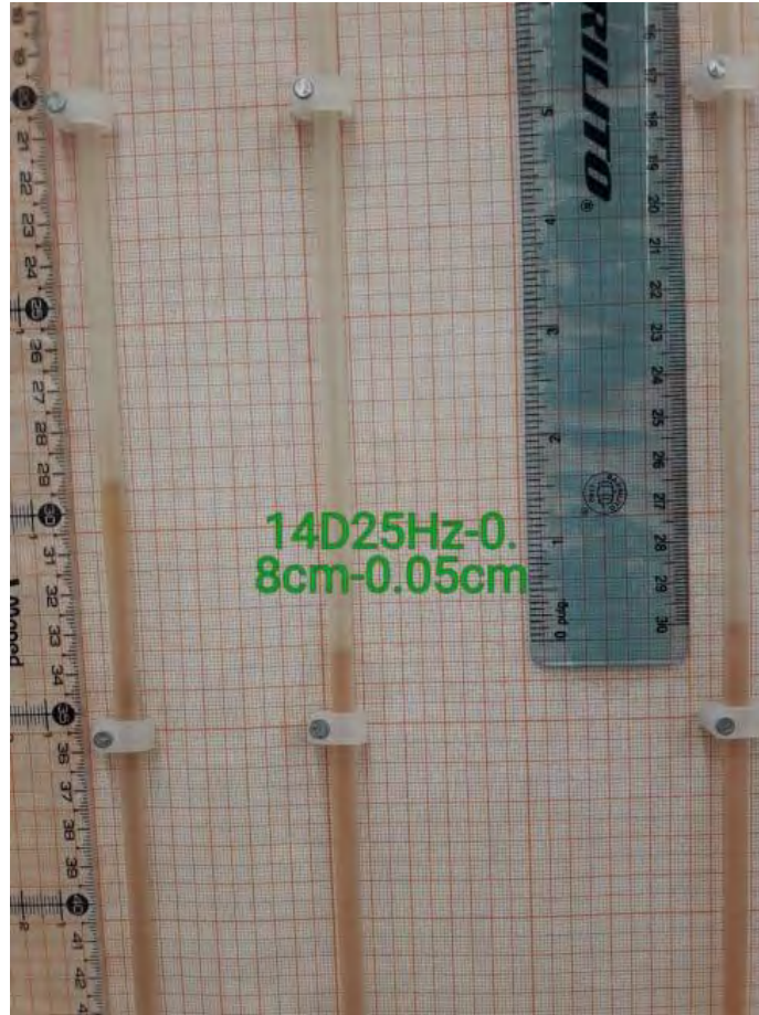
Figura 42. Varilla: "D", Frecuencia del motor: 25 Hz, y Altura: 14 cm, Altura de Columna de Agua: "A" (Dinámica) de 0.8 cm y "B" (Estática) de 0.05 cm.
