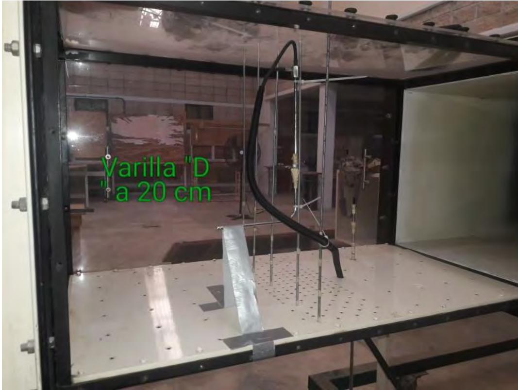
Figura 46. Tubo de Pitot Colocado a 20 cm del Suelo de la Zona Prueba en la Varilla "D".
