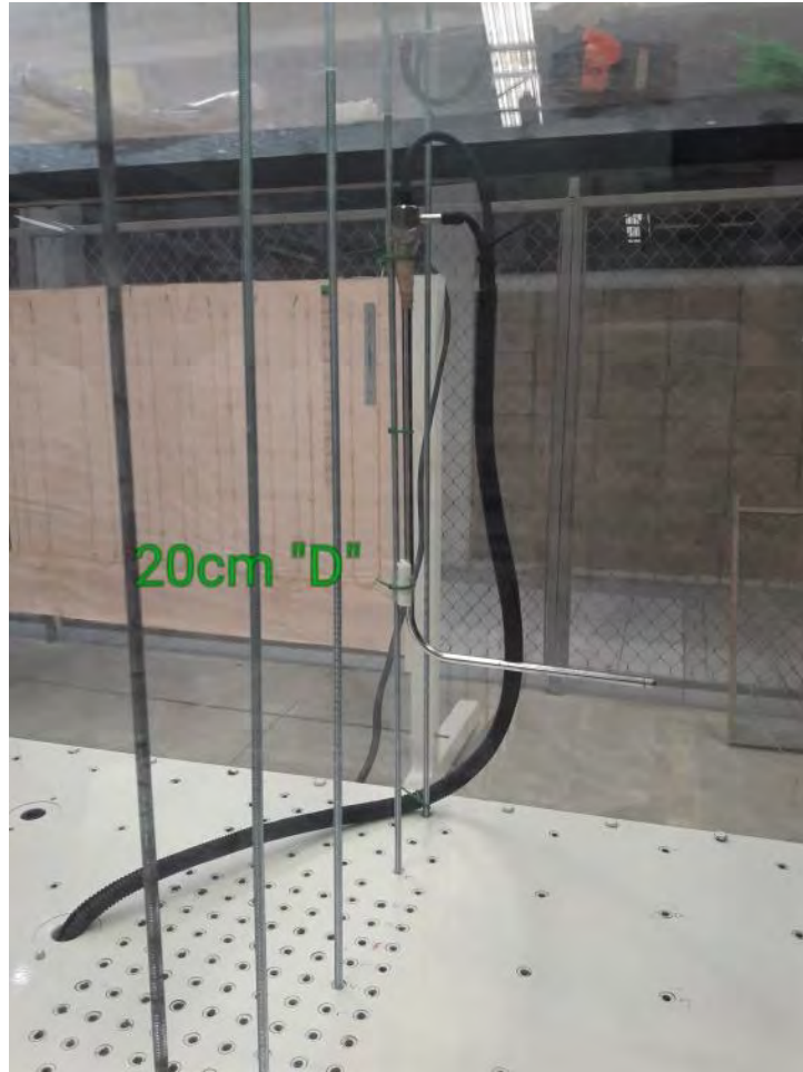
Figura 41. Tubo de Pitot Instalado en la Varilla "D" a 20 cm.
