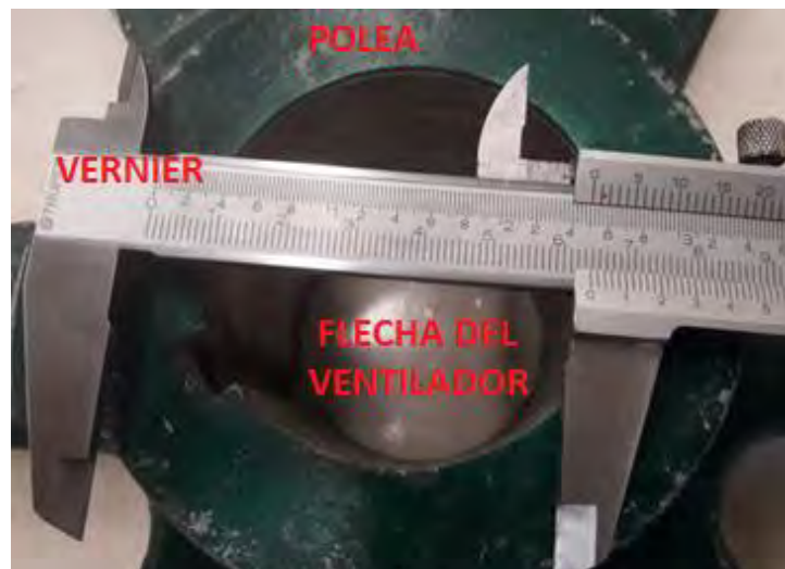
Figura 32. Vernier Para Medir el Diámetro Interior de la Polea de la Flecha del Ventilador.
