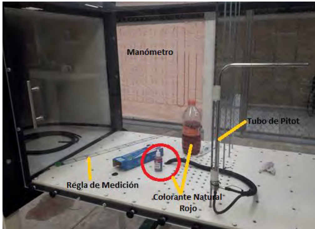
Figura 38. Instalación del banco de manómetro casero fabricado en la UQROO.
