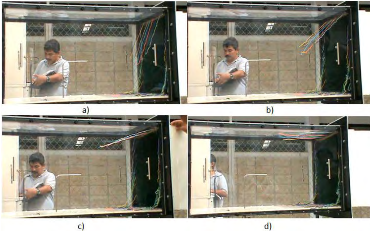
Figura 16. Primer Prueba Visual con Hilos de Algodón. a) Comienzo del movimiento a 1.5 Hz. b) Incremento de la frecuencia del motor a 2.5 Hz. c) Incremento de la frecuencia del motor a 5 Hz. d) Incremento de la Frecuencia del Motor a 15 Hz.
