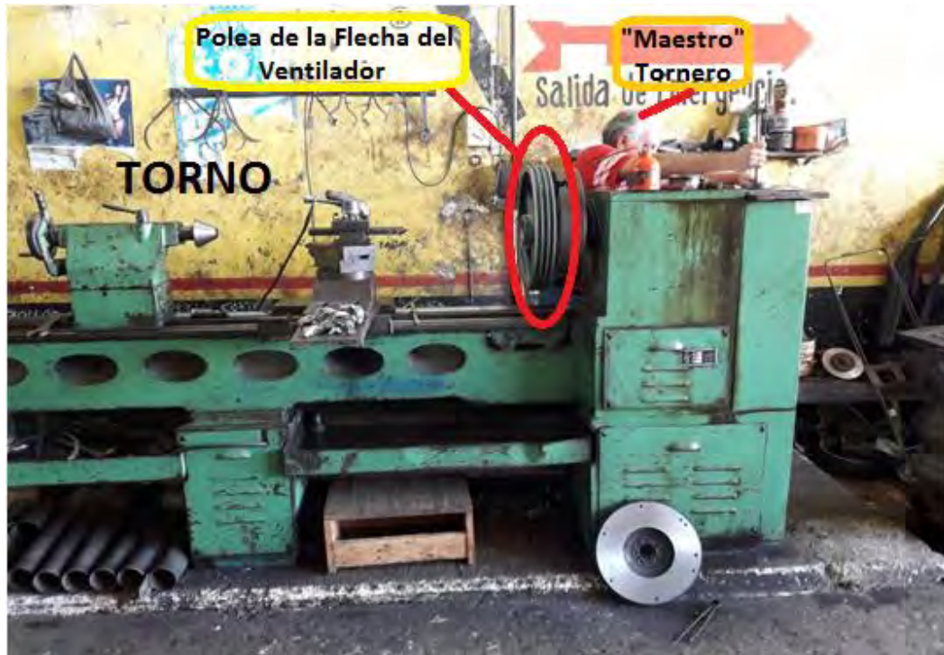
Figura 33. Proceso de Encasquillado de la Polea de la Flecha del Ventilador en el Torno.
