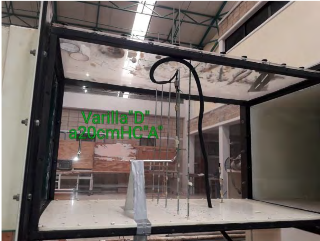
Figura 44. Tubo de Pitot Colocado en la Varilla "D" a 20 cm del Suelo de la Zona de Pruebas e Hilo Caliente Colocado en el Orificio "A".
