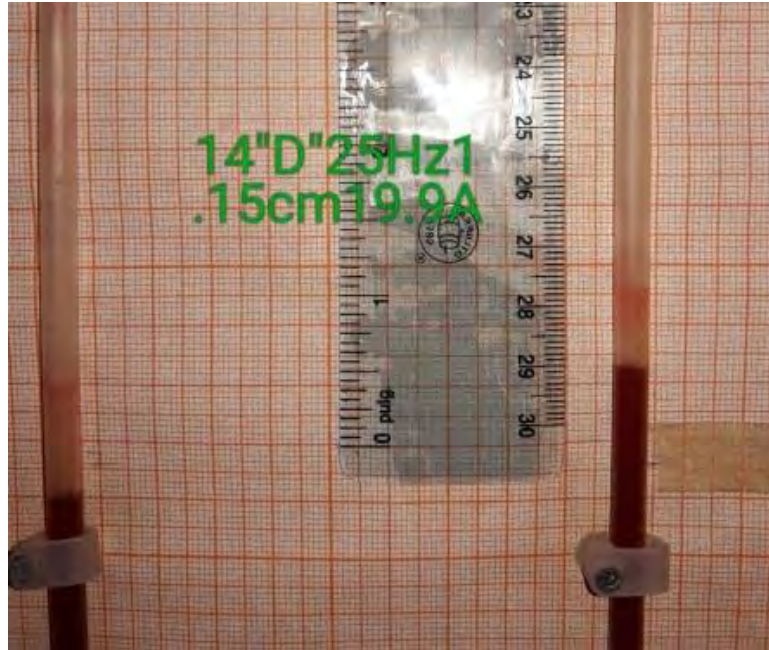
Figura 45. Varilla “D”. Frecuencia de Motor de 25 Hz. Tubo de Pitot Colocado a 14 cm del Suelo de la Zona de Pruebas. Altura de Columna de Agua “A” (Dinámica): 1.15 cm. Hilo Caliente “B”: 19.9 m/s.
