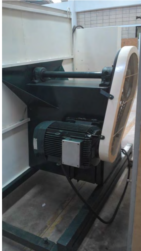
Figura 23. Motor del Túnel de Viento en su Base de Fábrica.
