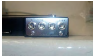
Figura 35 – Terminales de las puntas de prueba del miBot.
