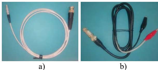
Figura 36 – Cables de conexión, a) cable con conector tipo osciloscopio, b) cable adaptador con conectores tipo caimán.
