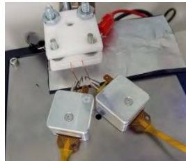
Figura 41 – Aplicación del método de 4 puntas en la muestra de aluminio.
