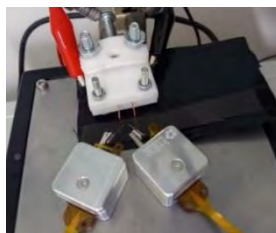
Figura 44 – Aplicación del método de 4 puntas a la tela carbón.
