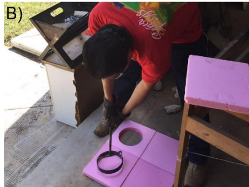
Figura 3 A) Imagen ilustrativa de herramienta de corte fabricada en solera de acero al carbón de \frac{1}{4} " de espesor y \frac{1}{2} " de ancho. B) Corte circular en placas de FOAMULAR.
