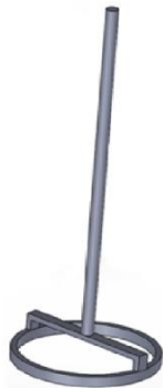
Figura 3 A) Imagen ilustrativa de herramienta de corte fabricada en solera de acero al carbón de \frac{1}{4} " de espesor y \frac{1}{2} " de ancho. B) Corte circular en placas de FOAMULAR.
