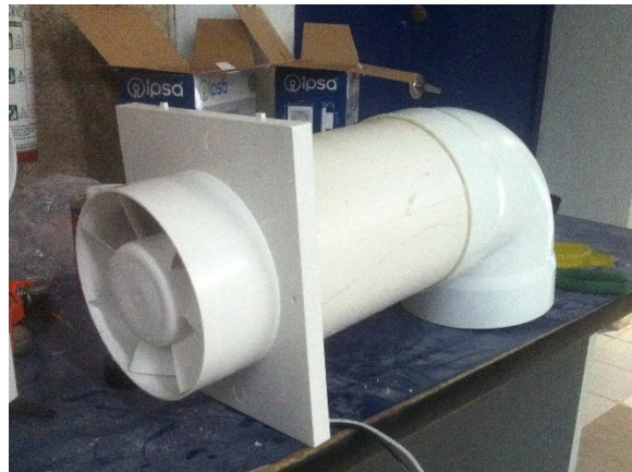
Figura 34. Acoplamiento de extractor de aire a la tubería de salida del intercambiador.
