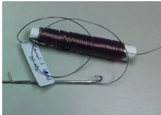
Figura 13. Termopar fabricado con guía de acero inoxidable.
