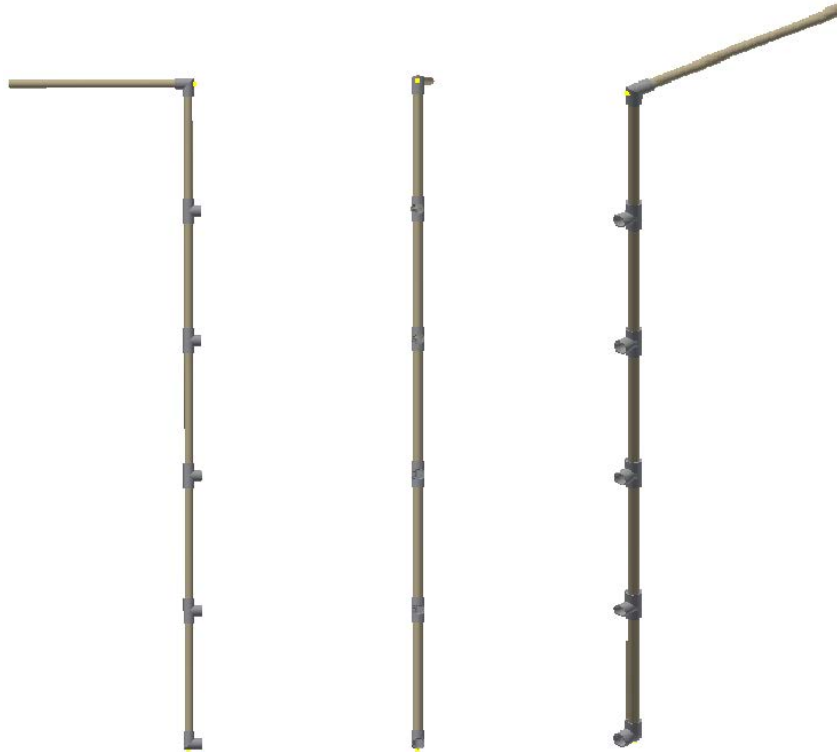
Figura 14. Vista lateral, frontal e isométrica de arreglo de sonda de temperatura de uso industrial para monitoreo de perfil de temperatura del suelo a distintas profundidades.
