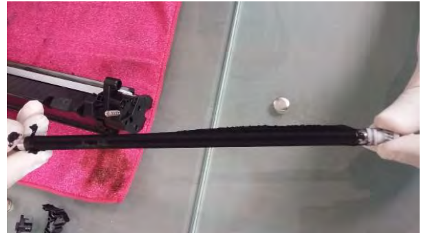
Fotografía 4. Extracción del rodillo, debajo se encuentra se encuentra el espacio para rellenar el cartucho con el polvo tóner.
