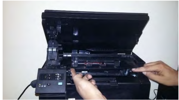
Fotografía 10. Prueba de confiabilidad del cartucho relleno en una impresora para realizar la impresión de una hora prueba.
