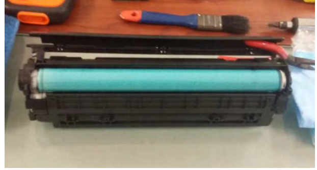
Fotografía 3. Desmontaje del cartucho con herramientas, paso 1 para el relleno con el tóner.
