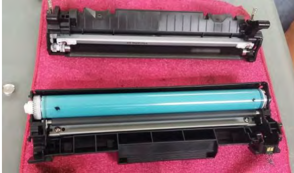
Fotografía 3. Desmontaje del cartucho con herramientas, paso 1 para el relleno con el tóner.
