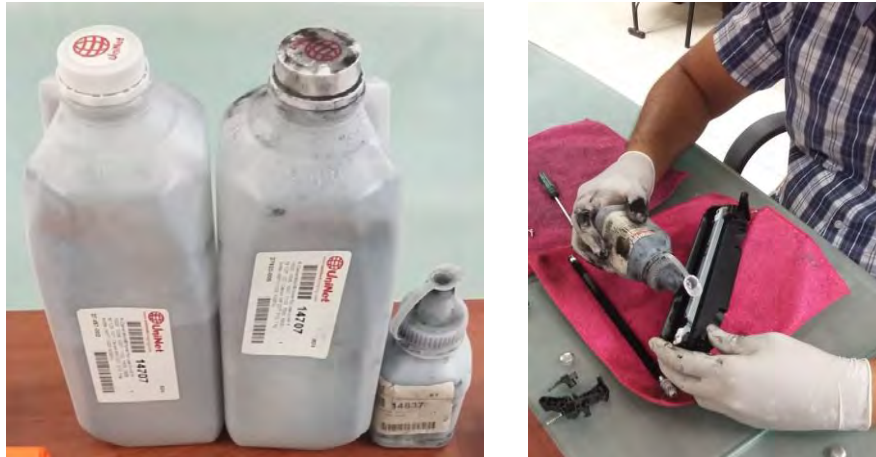
Fotografía 5. (Izquierda) Polvo tóner para el rellenado del cartucho y el vaciado del polvo tóner al cartucho (derecha).
