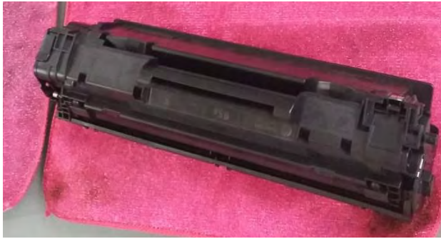
Fotografía 3. Desmontaje del cartucho con herramientas, paso 1 para el relleno con el tóner.
