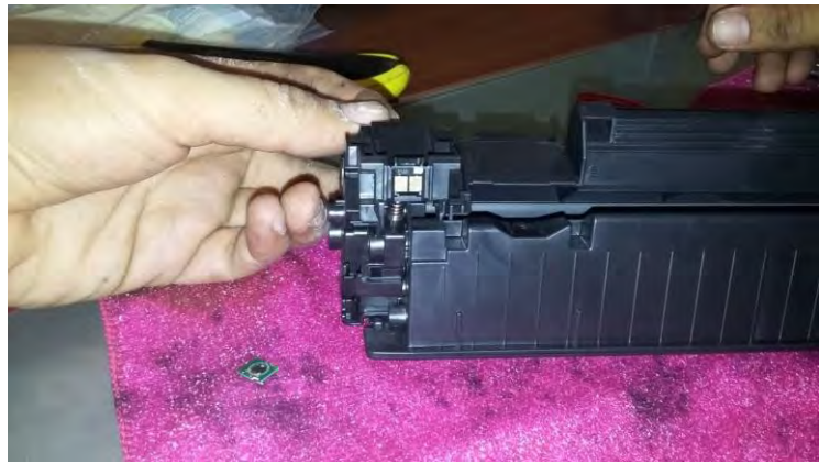
Fotografía 8. (izquierda) Extracción del Chip 85 A y el reemplazo con un nuevo Chip
