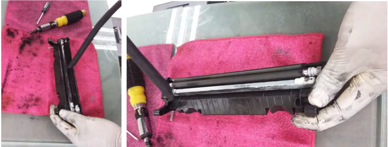
Fotografía 7. Succión del excedente de polvo tóner y la limpieza del cartucho para el siguiente paso.
