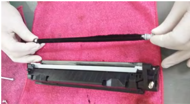
Fotografía 4. Extracción del rodillo, debajo se encuentra se encuentra el espacio para rellenar el cartucho con el polvo tóner.
