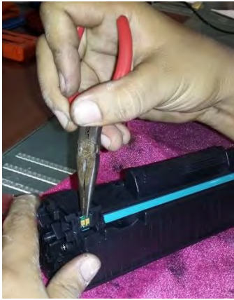
Fotografía 8. (izquierda) Extracción del Chip 85 A y el reemplazo con un nuevo Chip
