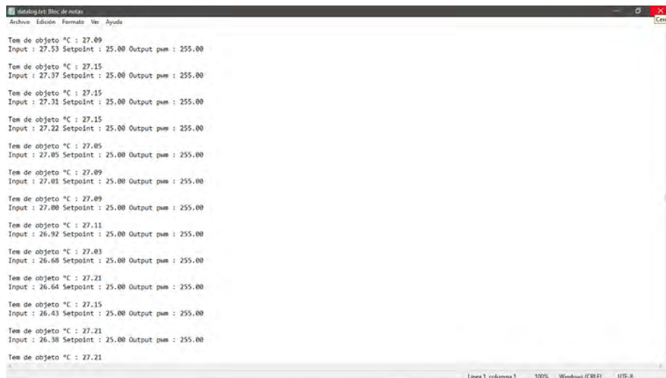
Figura 4.12 Medición del sistema de control de temperatura en el ID de Arduino.
