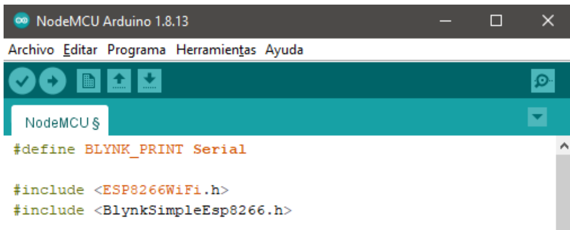
Figura 3.29 Librerías utilizadas en el sistema embebido NodeMCU ESP8266.
