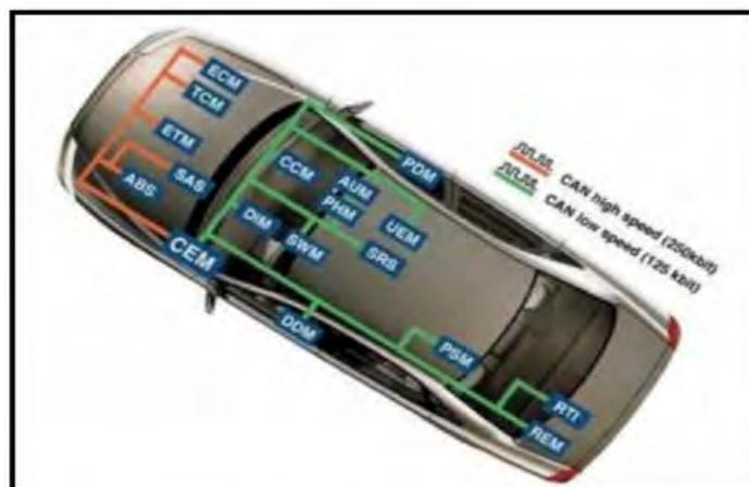
*Ilustración 15: El sistema CAN bus (Controller Area Network) permite a distintos dispositivos del vehículo poder intercambiar información entre ellos. (Anon., 2017)*
