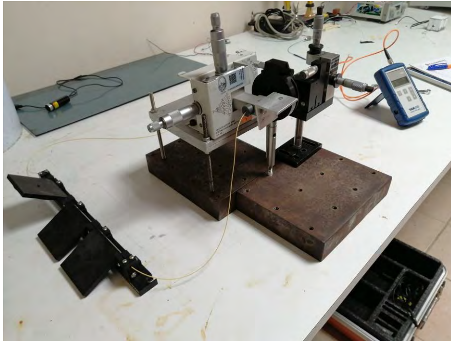
Figura 34. Implementación con el Controlador Manual de Polarización
