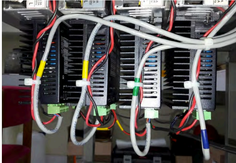
Fig. 3.14 Drivers fijados a sus respectivas fuentes con los cables asegurados por cinchos.
