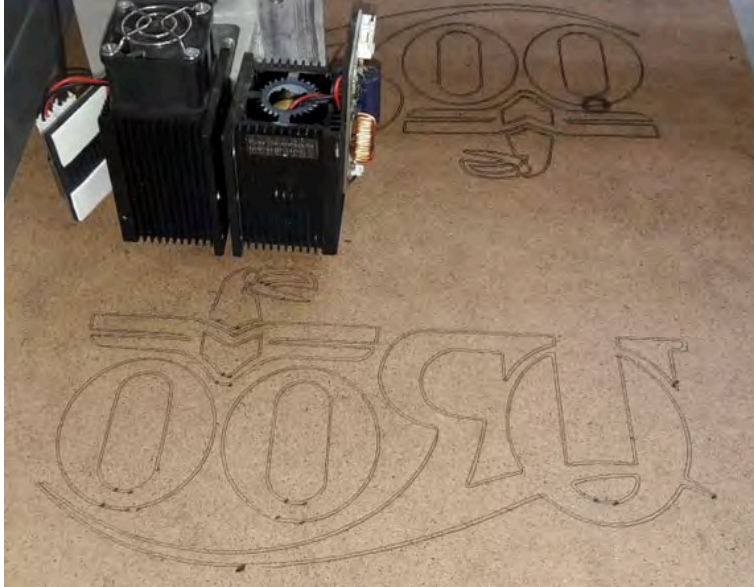
Fig. 4.5 Logo de la Universidad de Quintana Roo grabado con láser de 8 W a 2640 p/s o 2000 mm/min.
