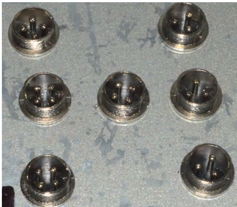
Fig. 3.8 Vista de los nuevos conectores para motores (4 hilos) y sensores (3 hilos).
