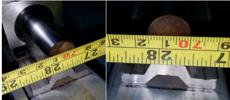
Fig. 2.18 Distancia entre extremos de rieles en Y.
