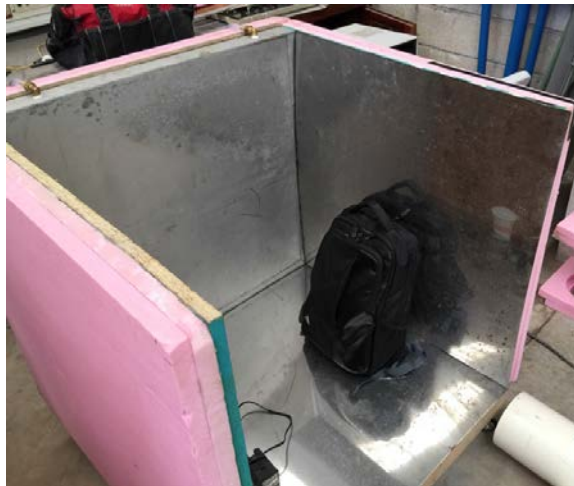
Figura 12. Paredes forradas con paneles de acero inoxidable
