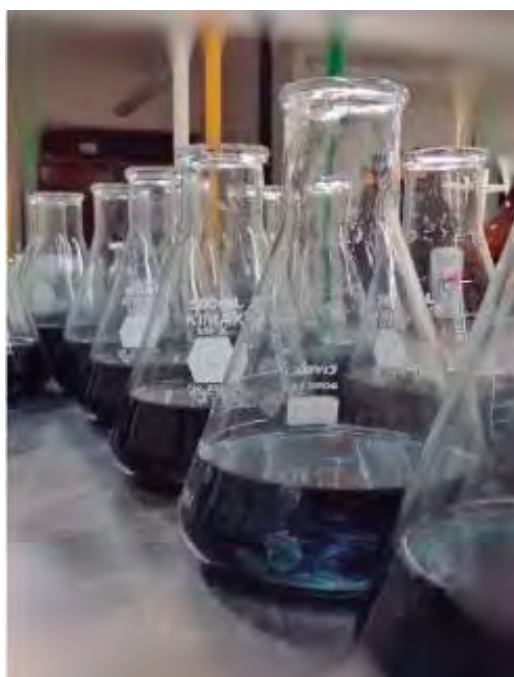
Figura 23. Análisis de materia orgánica con el método de Walkley y Black. Titulación de las muestras. Laboratorio de Recursos Naturales. Abigail A.C, 2018.
