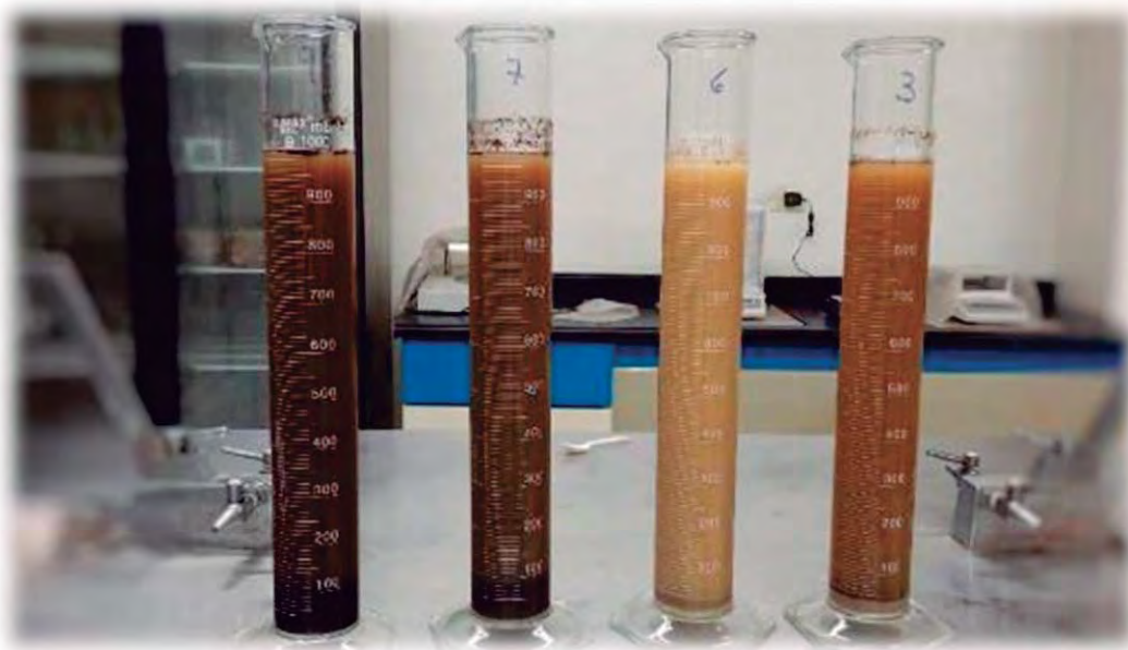
Figura 24. Determinación de la textura del suelo mediante el procedimiento de Bouyoucos. Laboratorio de Recursos Naturales. Abigail A.C, 2018.
