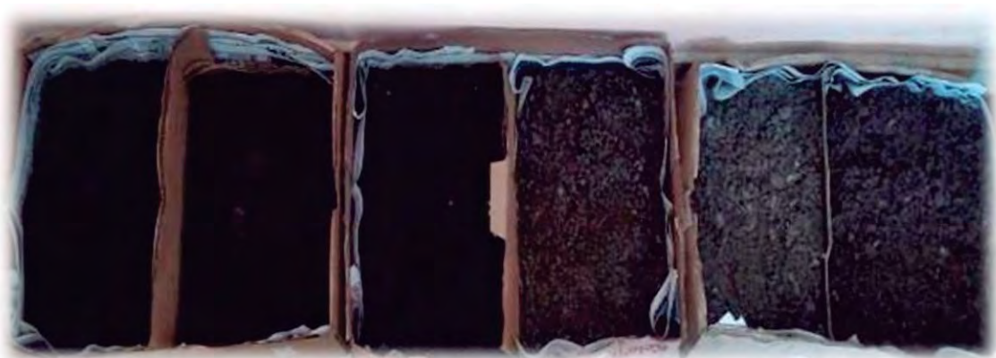
Figura 18. Muestras de suelo colocadas en bandejas de cartón para secarlas bajo sombra. Abigail A.C, 2018.
