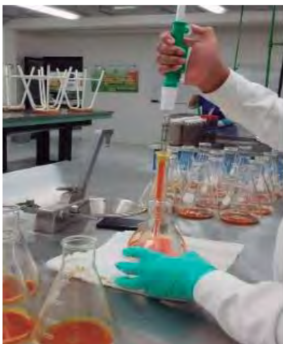
Figura 22. Análisis de materia orgánica con el método de Walkley y Black. Colocación de dicromato de potasio. Laboratorio de Recursos Naturales. Abigail A.C, 2018.
