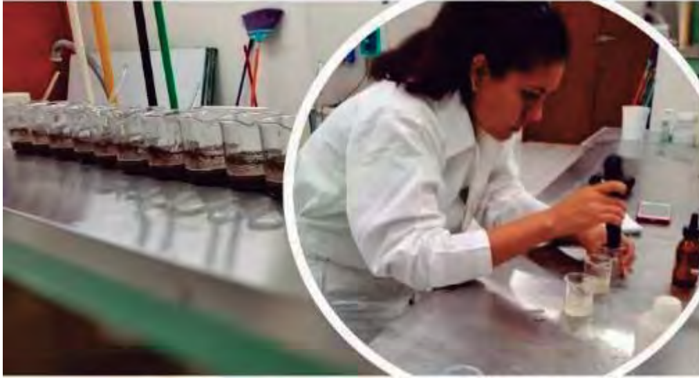
Figura 20. Determinación de pH mediante el método electrométrico en una solución de agua pura. Laboratorio de Recursos Naturales, UQROO. Abigail A.C. y Dr. P. Frago, 2018.
