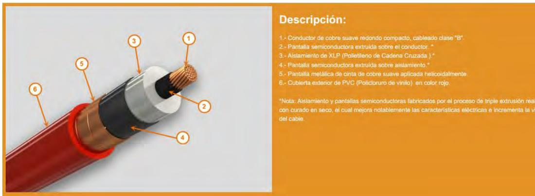
*Fig. 2. 13 Cable xlp con aislamiento de 5 a 35 Kv.*
