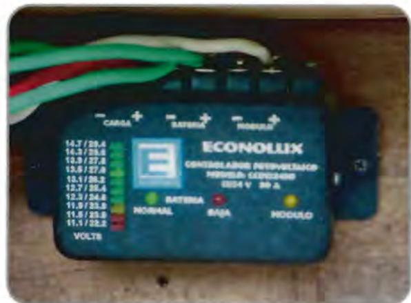
Figuras 3.9 y 3.10 Fotografías del controlador de carga del sistema fotovoltaico.
