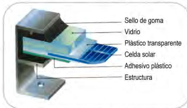
**Figura 2.5** Esquema de componentes de un módulo fotovoltaico.
