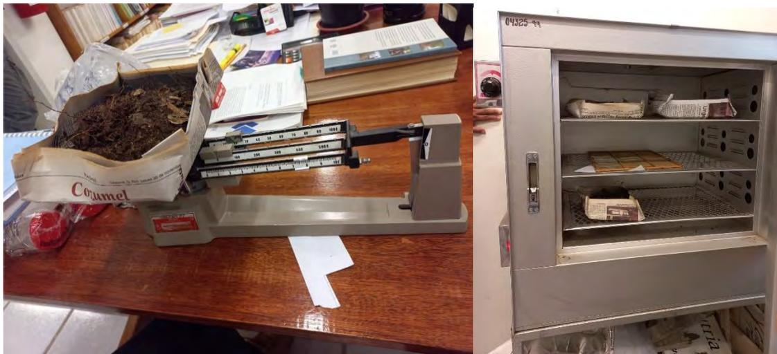
Figura. 10.- Pesaje de suelo y estufa para secar humedad. Foto: Hernández, N.
