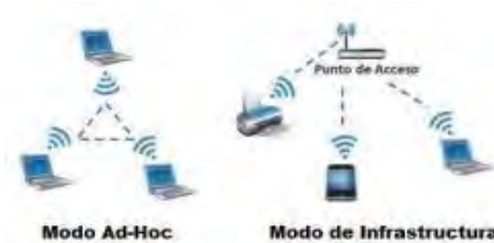
Figura 11 Modos de funcionamiento inalámbrico [19.]
