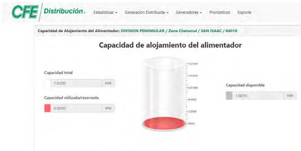
Figura 6.19. Grafica de Generación Distribuida SNI04010.
