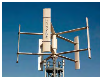
Figura 8. Turbina eólica de eje vertical Darrieus (giromill). Fuente: Portillo, s.f.
