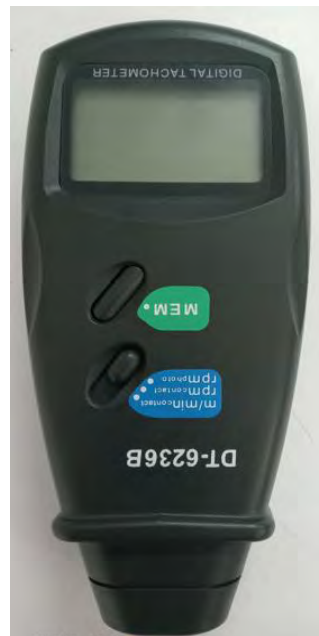
Figura 31. Tacómetro digital. Fuente: Elaboración propia.
