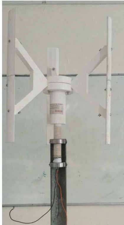
Figura 27. Rotor y generador acoplados a una base metálica con rodamiento. Fuente: Elaboración Propia.
