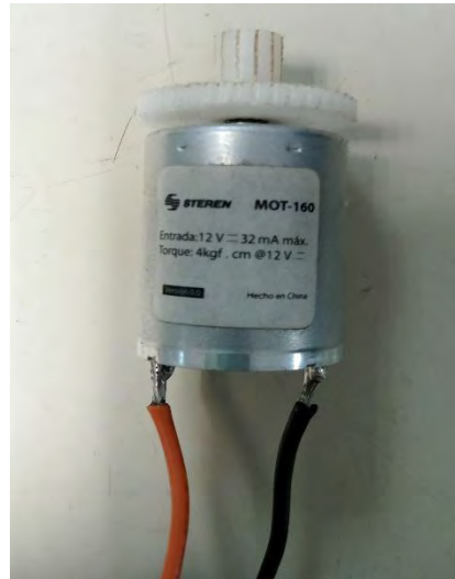
Figura 15. Motor Generador de imán permanente de 0.42 W. Fuente: Elaboración propia.
