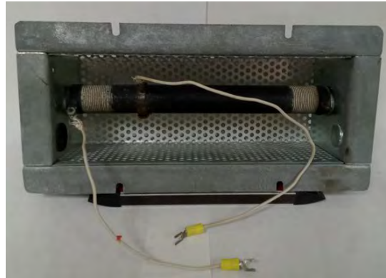
Figura 30. Resistencia de cerámica de 100 \Omega . Fuente: Elaboración propia.
