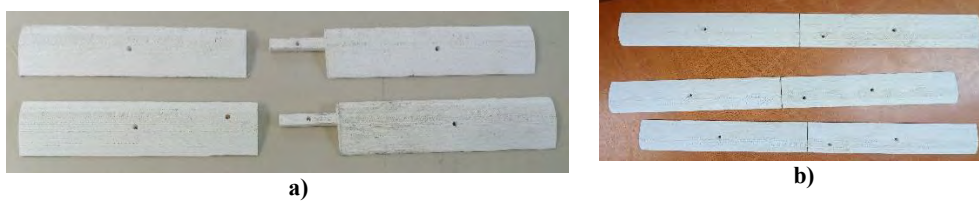
Figura 23. Aspas de PLA a) Piezas de las palas y b) Aspas ensambladas. Fuente: Elaboración propia.
