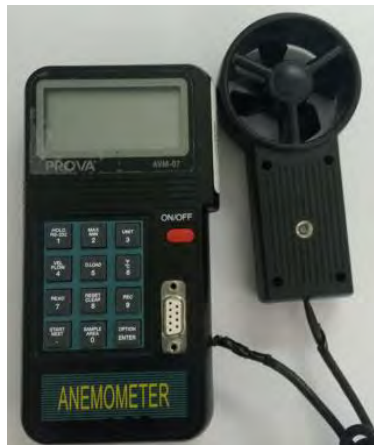
Figura 34. Anemómetro PROVA AVM-07. Fuente: Elaboración propia.
