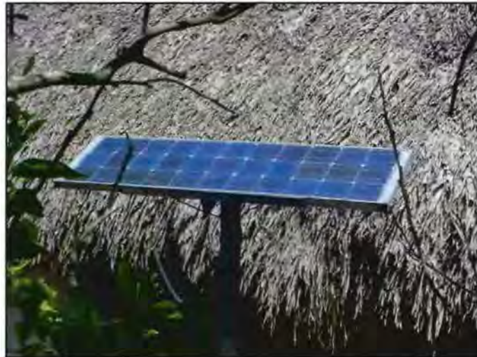
Figura 3.4 Fotografía de un modulo fotovoltaico en la que se observan puntos calientes los cuales son las partes mas claras del modulo fotovoltaico.
