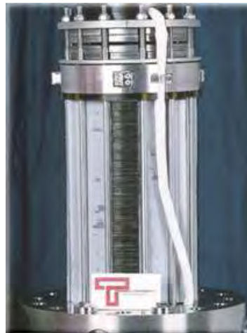
Figura 4.3 Electrolizador ESP de 100 KW usado para producir 106 litros por minuto de O_2 para su uso en submarinos.
