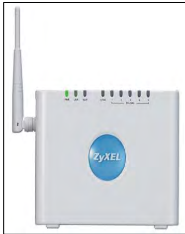
Figura 3.3 Dispositivo CPE (Equipo Local del Cliente)
