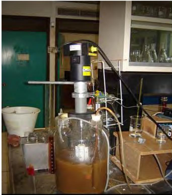
Figura 2.5.- Respirómetro utilizado para estimar parámetros del proceso nitrificante del ejemplo descrito.
