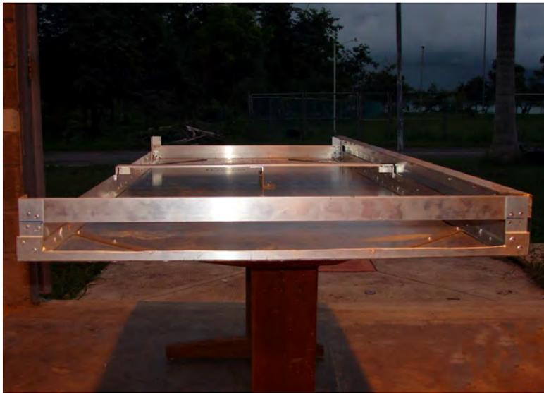
*Figura 3.22 Refuerzo central para soportar la lamina absorbadora*
