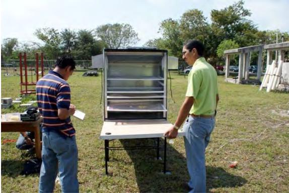
Realizando pruebas en el secador con termopares producto en una de los pocos días con las condiciones ideales de sol.
