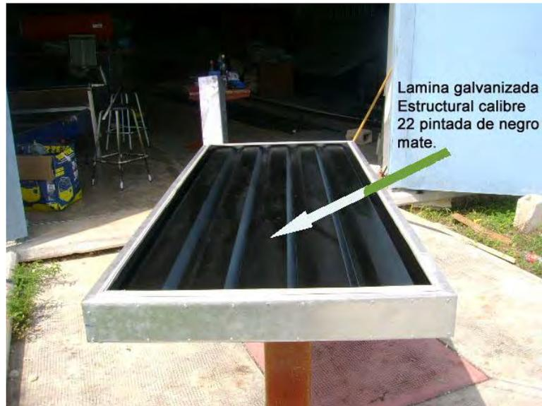
*Figura 3.26 Colocación de la lámina comercial pintada y montaje del cristal de 6mm sobre la cámara aislada.*
