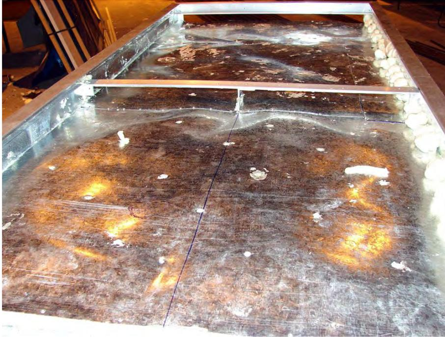
*Figura 3.25 Colector aislado por completo aún con excedentes de espuma aislante.*
