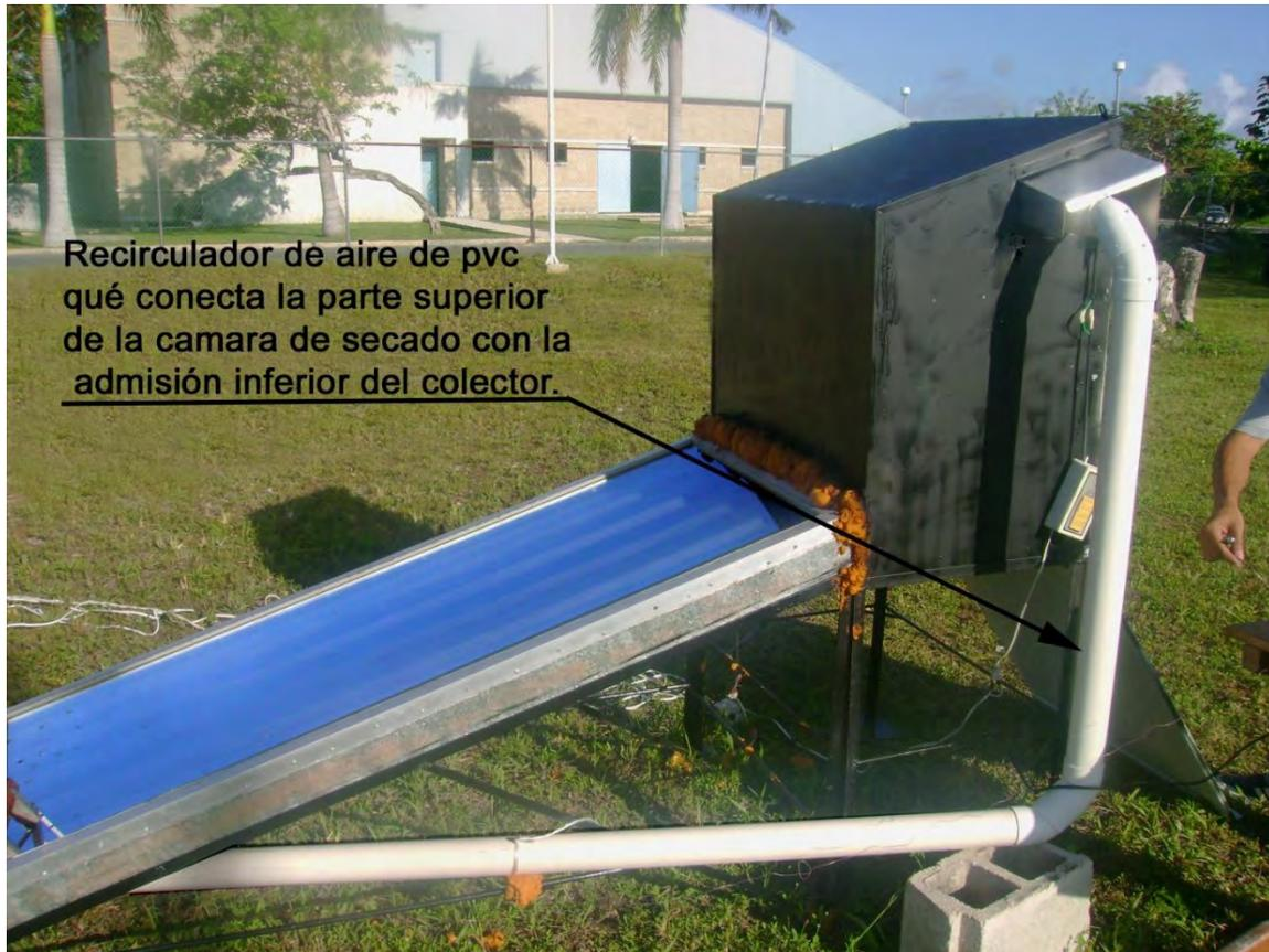
*Figura 3.34 Deshidratador solar de productos agrícolas terminado y deshidratando productos*
