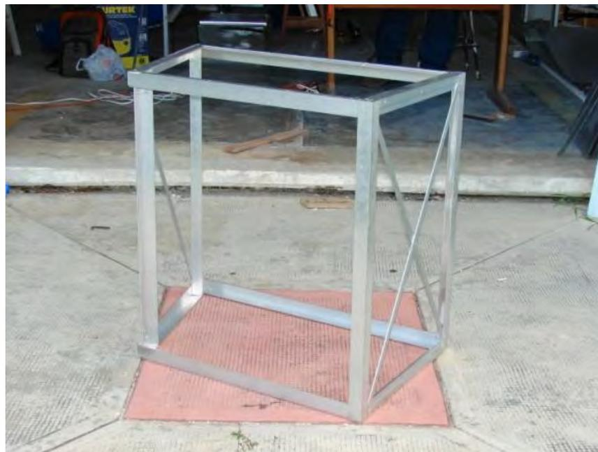
*Figura 3.8. Refuerzos de los laterales de la estructura de la cabina.*
