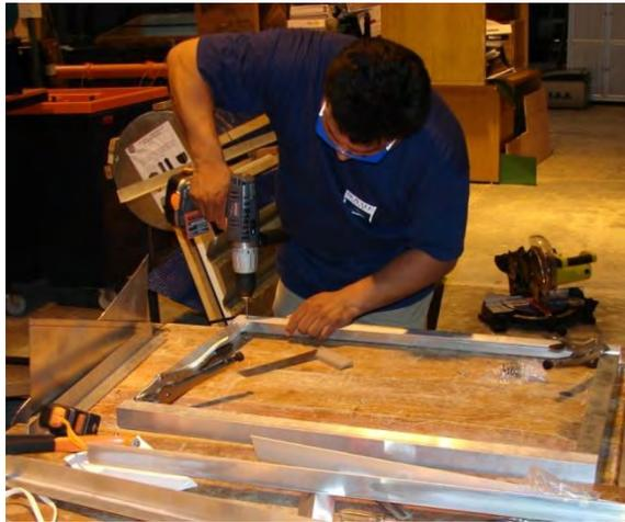
*Figura 3.5 Armado de la base de la cabina de secado*
