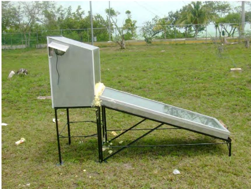
*Figura 3.33 Cámara-colector con unión aislada.*
