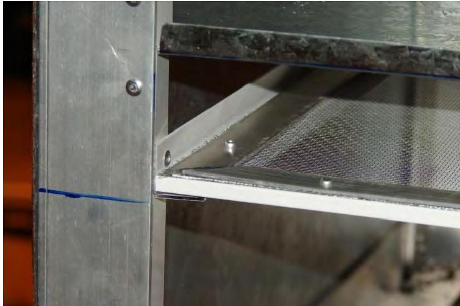
*Figura 3.15 Detalle del espacio entre la canalización y la malla de secado.*
