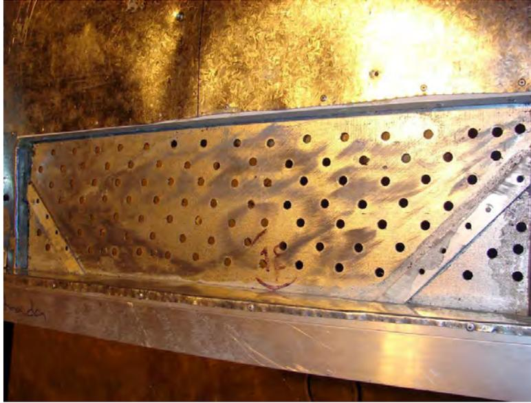
*Figura 3.21 Orificios de admisión de aire en la parte baja del colector.*
