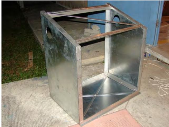
*Figura 3.11. Forrado de la estructura de la cabina de secado.*
