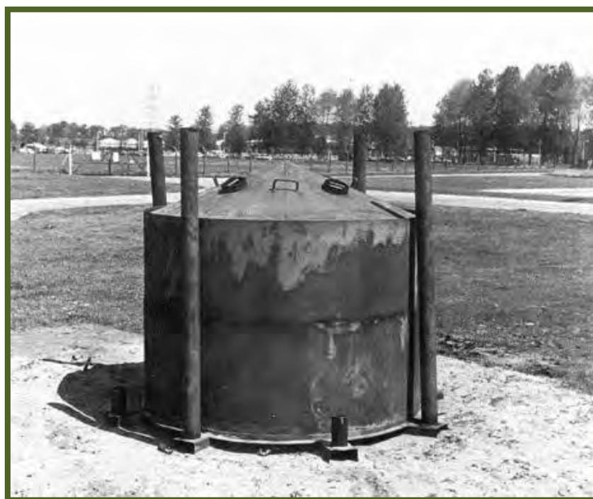
**Figura 1.** Fotografía de un horno metálico transportable. (Foto, TPI)
