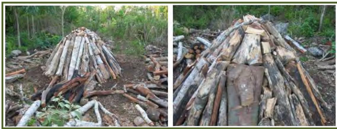
**Figura 12.** Fotografías del estibado de la madera para la formación del horno en la comunidad El Pocito. (Foto: Leyva, 2008.)
